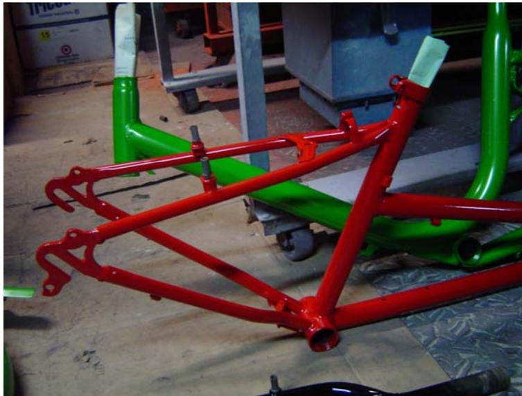
El marco con la horquilla pasan a la etapa final, denominada armadura, en la cual se agregan los frenos, reflectantes, el asiento, guardabarros, pedales, piñones, bielas etc.
