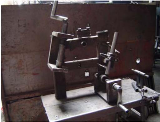
Machina para montaje de marco y soldadura
