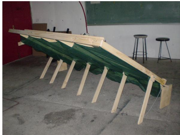
El material flexible que conforma las bandejas debe ser descartado por presentar problemas con el armado y arriostamiento de la estructura, en su lugar necesariamente debe incorporarse una pieza rígida.
