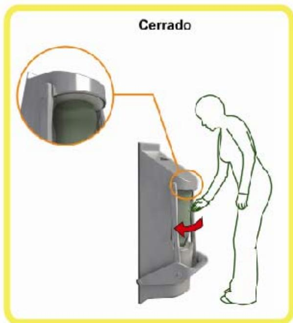
El pedal no puede ser accionado si la tapa no está completamente cerrada, otorgándole seguridad al usuario.
