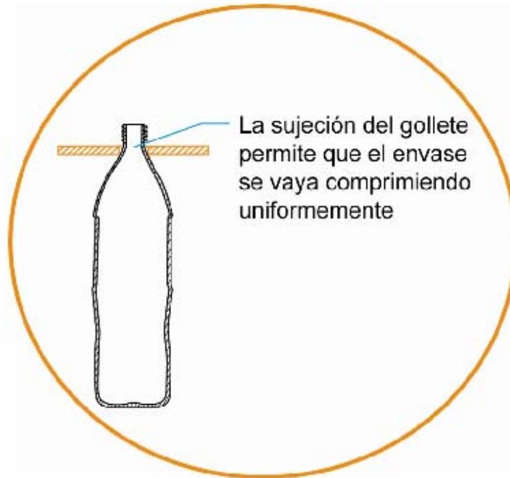
Mediante la realización de los ensayos de compresión, se pudo determinar que la compresión vertical es la más óptima, ya que, ejerciendo la misma fuerza, se logra una reducción del volumen mayor que en una compresión horizontal.
