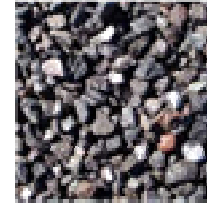
GRAVILLA 20-5: Arido grueso especialmente fabricado para mezclas de hormigon segun NCH163 del Laboratorio Nacional de Validad (LNV)
