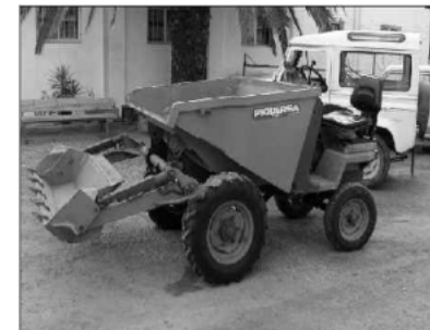
Dumper con pala para autocarga, Transporte al interior de la planta.
