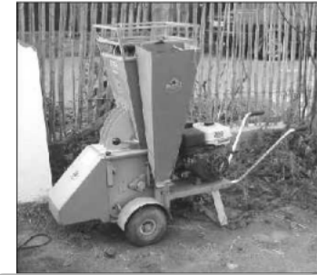
Triturador móvil de gasolina, Reducción de tamaño.
