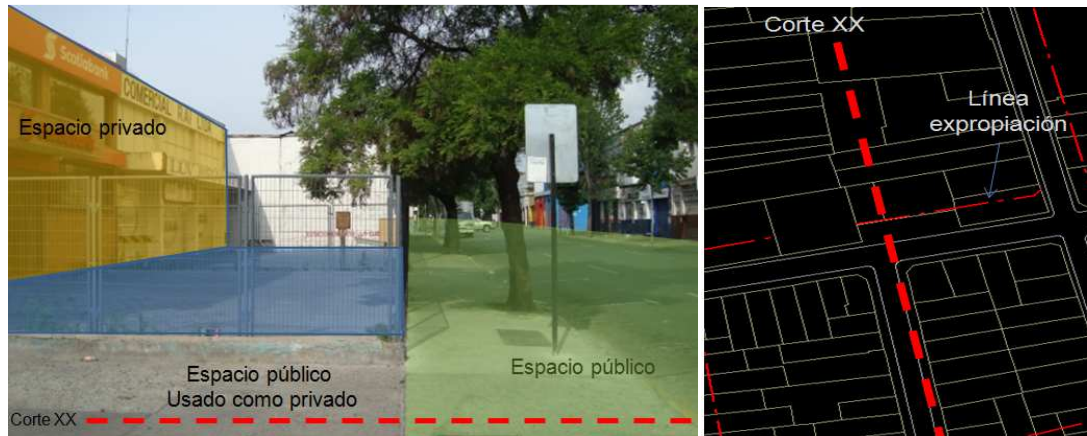
Figura 29. Efecto de la aplicación parcial de la franja de expropiación efecto “bahía”
