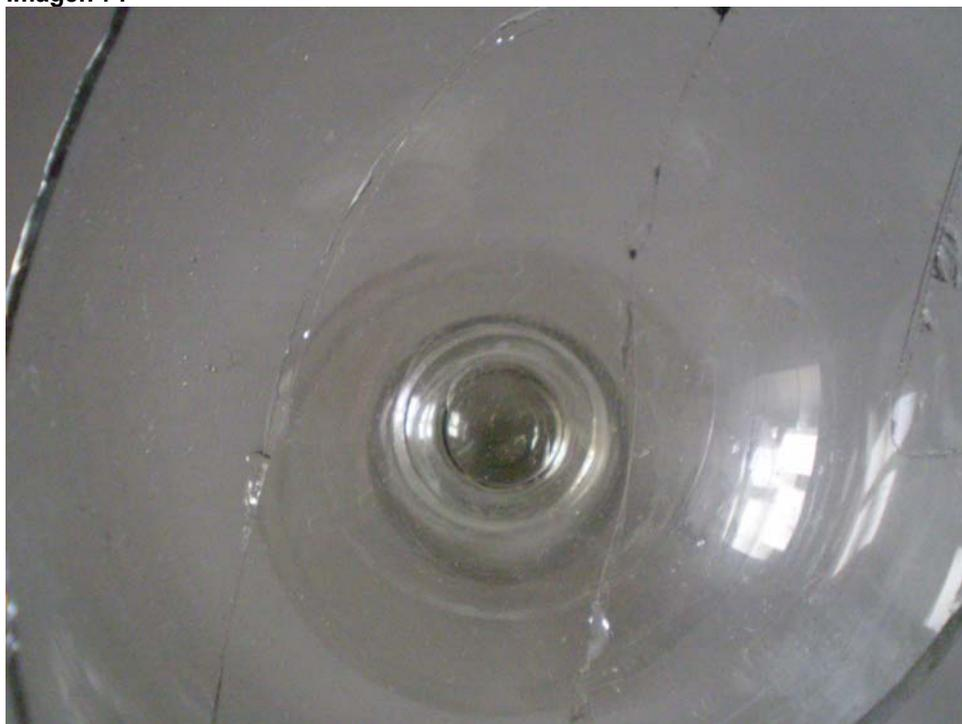
Fotografías que muestran las líneas de fracturas prácticamente invisibles con el pegamento ya aplicado.
