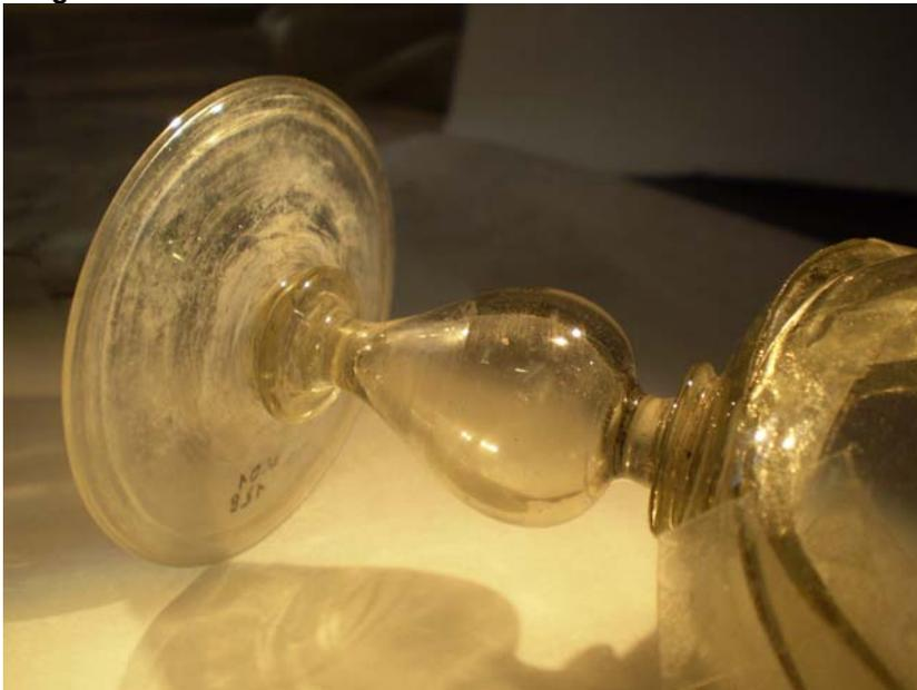
Fotografía con luz transmitida donde se muestra el daño en el vidrio, en este caso en la base del pie de la copa.
