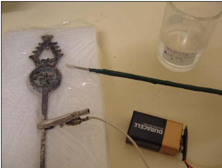
*Fig. 25.- Imagen que ilustra equipo y procedimiento de limpieza electroquímica localizado.*
