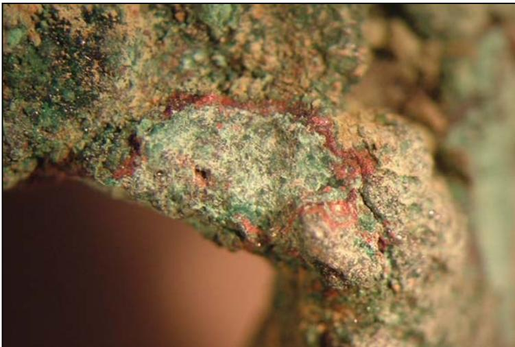
*Fig. 26.- Punto de corrosión extraída. Fotografía digital microscopio estereoscópico 16x.*
