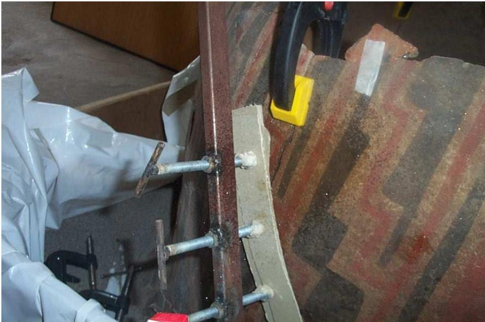
A continuación se utiliza las prensas que mediante una regulación o ajuste continuo van disminuyendo el grado de descalce.
