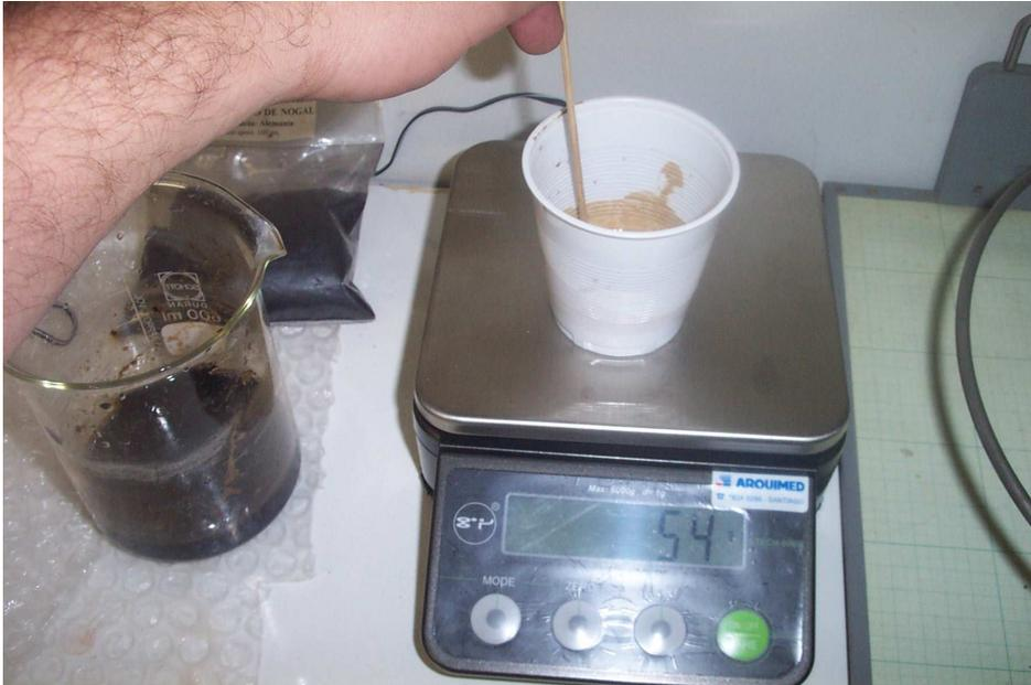
Para el resane que se aplicara en la parte interna se busca bajar el tono del yeso mediante la adhesión a este de un producto que sea compatible químicamente con el yeso pero que a su vez pueda acercarse más al tono de la cerámica.
