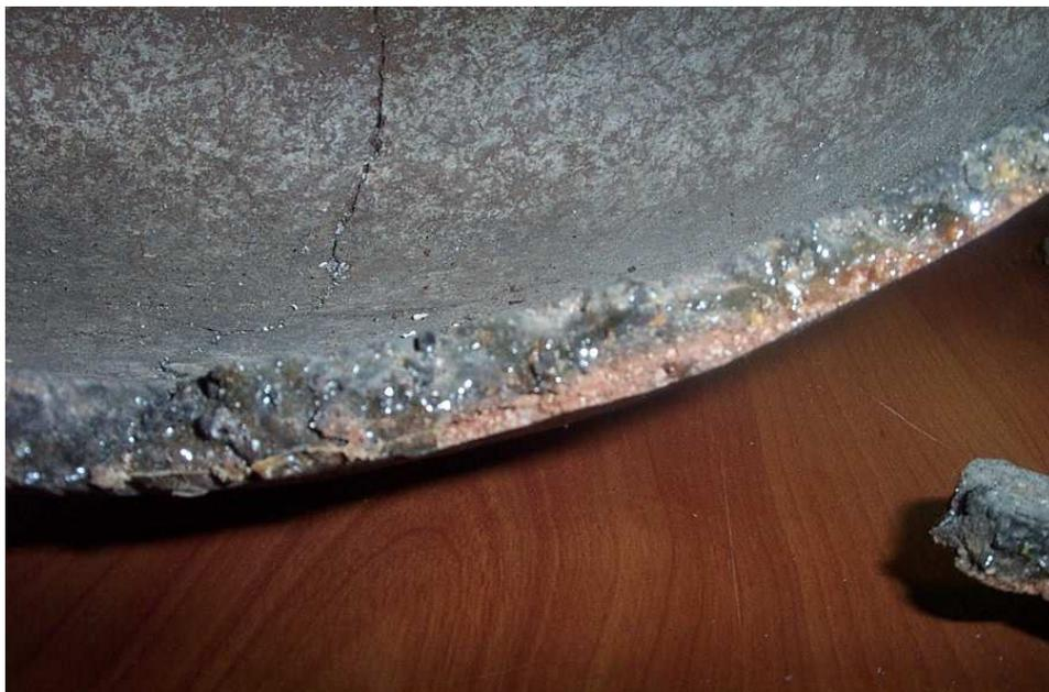
Detalle de un fragmento con gruesa capa de **agorex** la que provoca un alto grado De disgregación de la pasta e importantes descalces.
