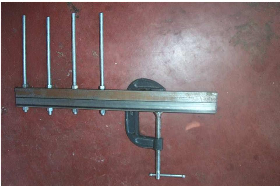
Prensa con los hilos dispuestos, solo falta soldar el travesaño que une ambas piezas de metal por la parte superior.
