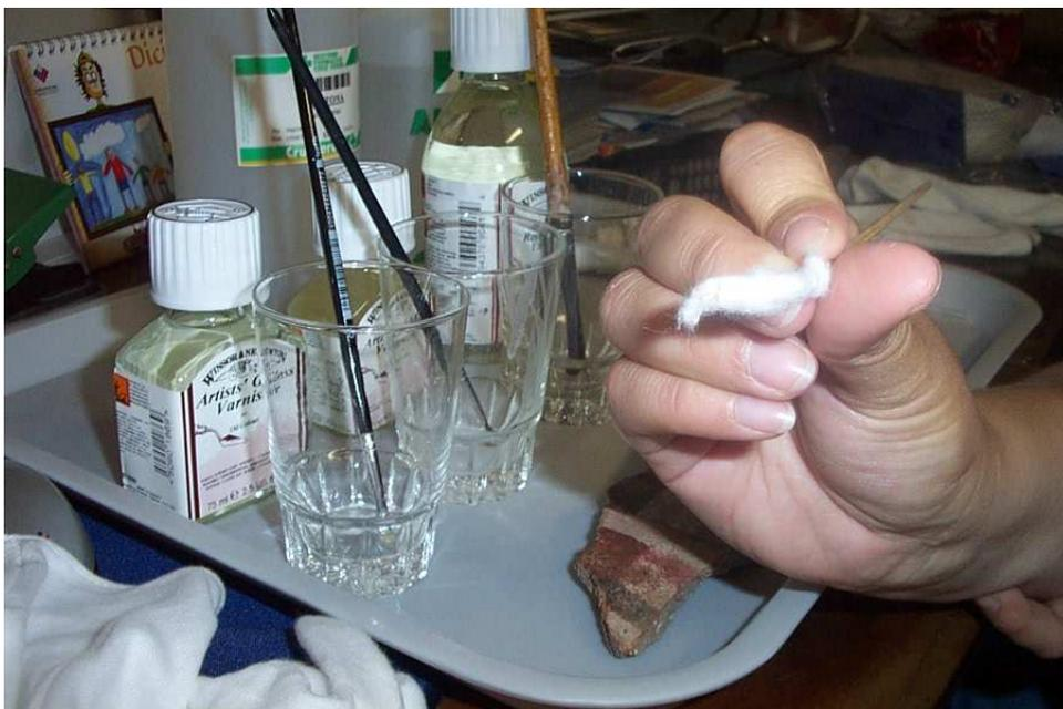
Finalmente se realiza un test para evaluar el grado de pérdida de pigmento. se consideró que el barniz de retoque **Winsor and Newton** al 75% en alcohol responde a los requerimientos de opacidad y protección de la capa superficial de la pieza.
