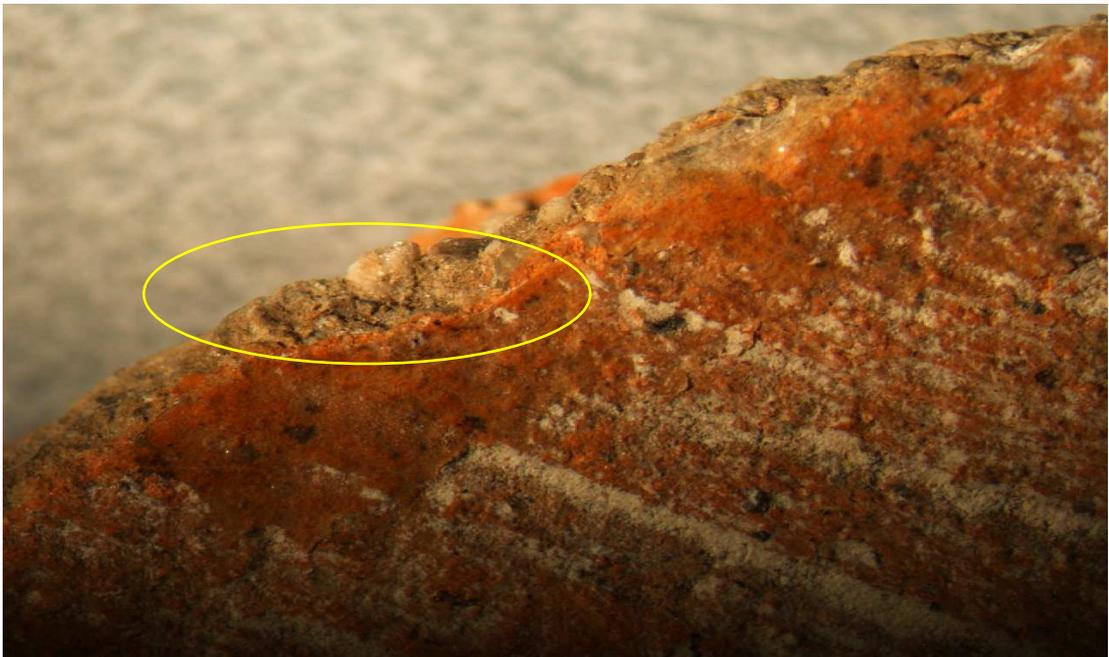
**Fotografía 3x** vista del borde con capa de adhesivo y grueso antiplastico
