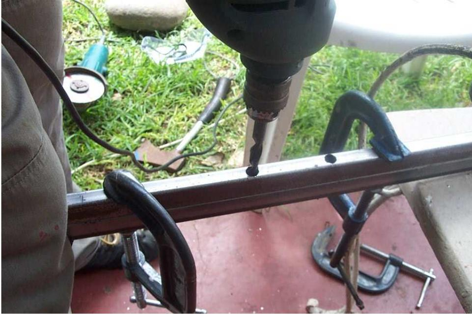
Para este fin se utiliza perfiles metálicos de dos pulgadas junto a tubos de acero con hilos.
