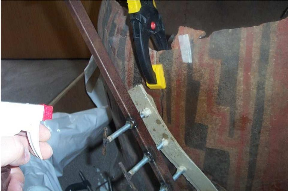
Durante el proceso de regulación de las prensas la cerámica se mantiene hidratada para lograr una mayor flexibilidad de esta.
