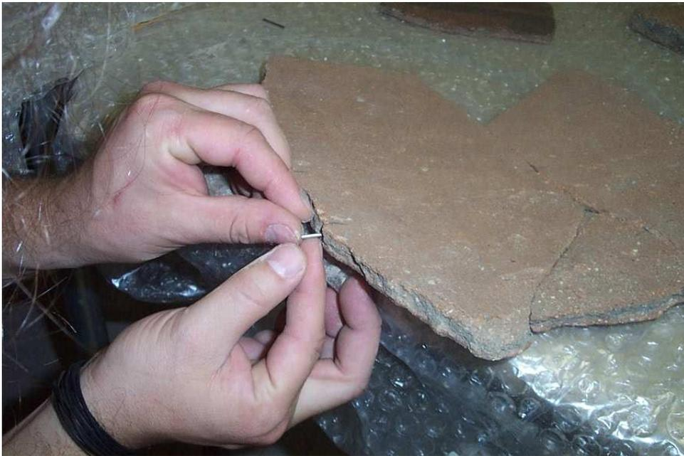
Detalle de la introducción y testeo de un tarugo de acero inoxidable.
