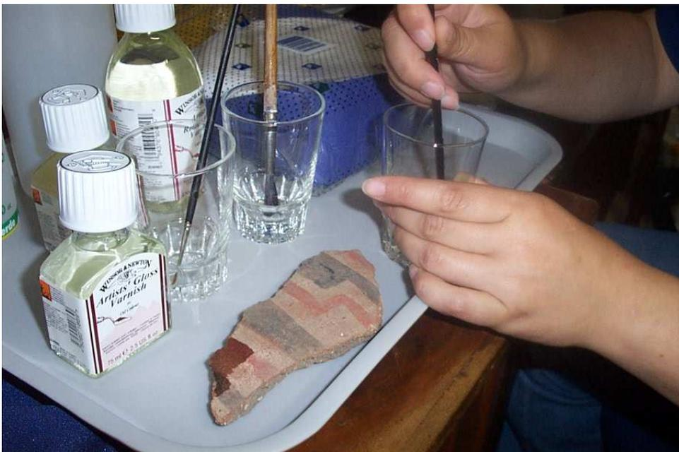
**Test de consolidantes:** la cerámica a restaurar posee la particularidad de tener una decoración post-cocción (ver análisis con lupa estereoscópica) lo que implica una serie de pruebas para consolidar el pigmento adherido a la superficie de este.
