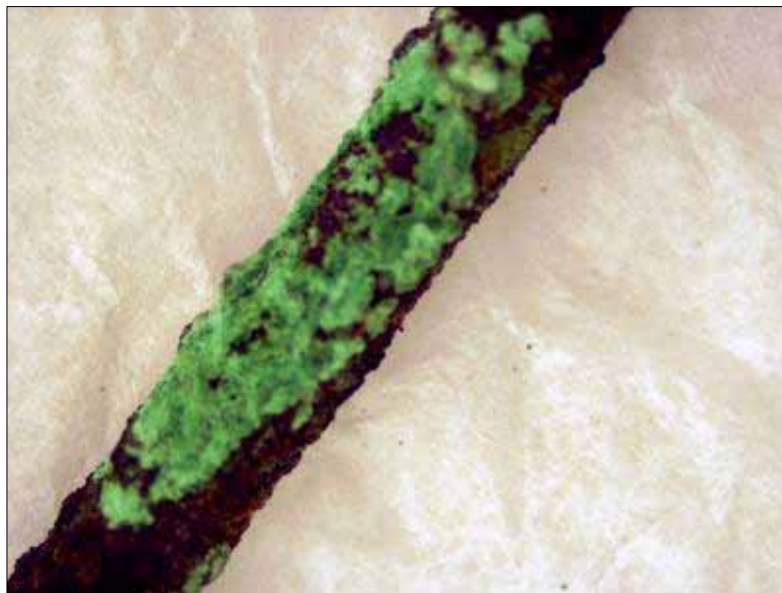
Microfotografía 5x Detalle de corrosión activa (Neyra G. 2009) Fig. N°42
