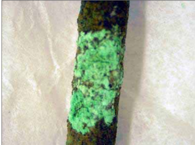
Microfotografía 10x Detalle de corrosión activa (Neyra G. 2009) Fig. N°41
