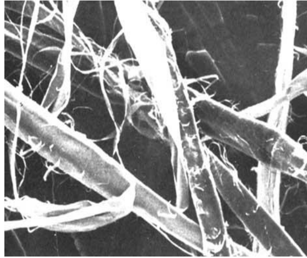
Fibras largas de papel de pulpa mecánica (200 aumentos).
