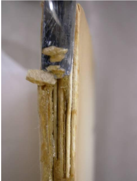
Retiro de cola antigua
