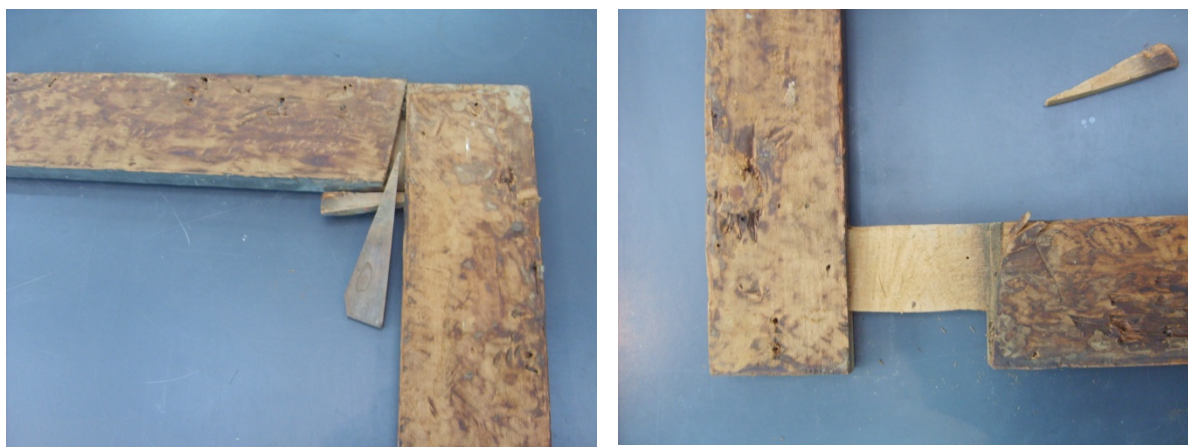
Fig.28 Detalle del bastidor. Nótese ensamble, cuñas. La gran cantidad de agujeros y Restos de papel oxidado y adherido
