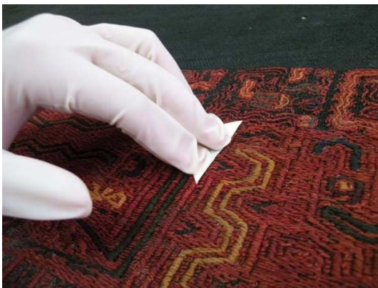
Imagen 65: Prueba de solidez del color.
