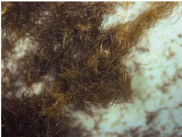
Imagen 98: Microfotografía estado de los hilos de la base; algodón (30x).
