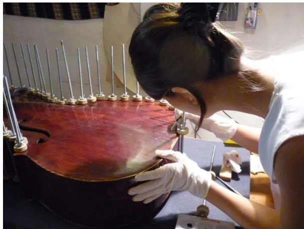
Fig. 26: Proceso de reintegro de barniz.
