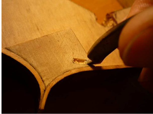
Fig. 97: Tallado de ranuras para incrustación de contra-fajas.
