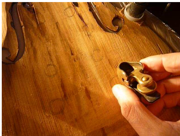
Fig. 63: Corrección de espesores de la tapa armónica.
