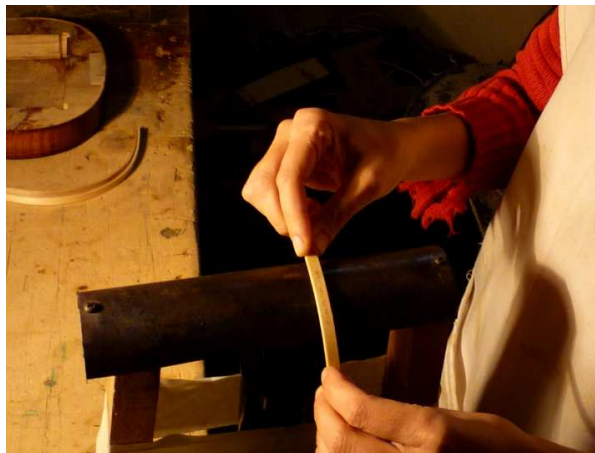
Fig. 95: Proceso de curvatura de las contra-fajas.
