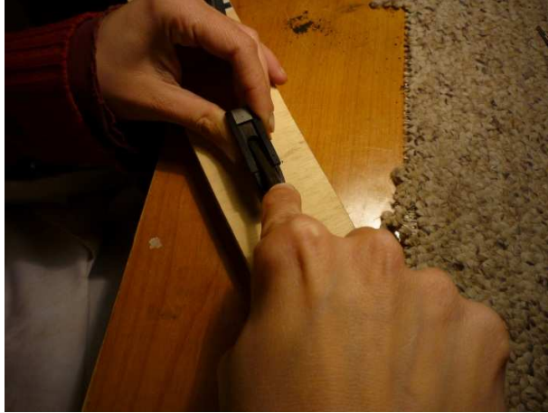
Fig. 116: Tallado de paredes de la morteza. Se hizo más honda la cavidad en dirección al tornillo de la nuez.
