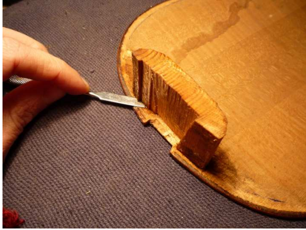
Fig. 53: Remoción del taco superior.
