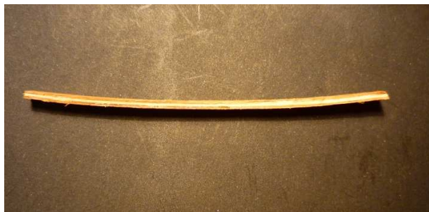
Fig. 84: Filete nuevo para incrustación en faltantes.
