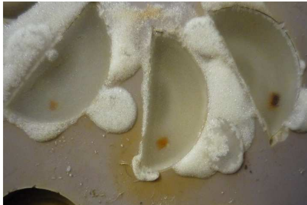
Fig. 45: Processo de encapsulamiento de las muestras en resina transparente.
