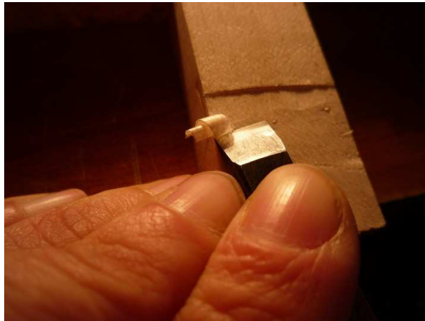
Fig. 102: Tallado de abeto para doblaje de botón.
