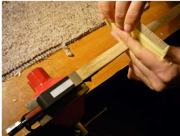
Fig. 120: Peinado de crines para atar el extremo que irá inserto en la cabeza.
