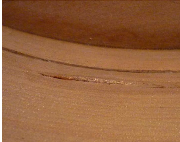
Fig. 15: Fisura mal nivelada en la faja del instrumento.
