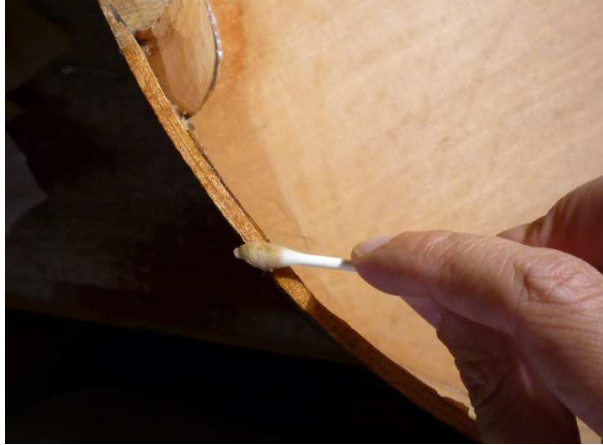
Fig. 12: Proceso de humectación del adhesivo de bordes de contacto.
