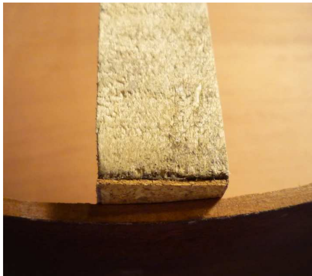
Fig. 7: Detalle de uno de los listones para evitar la deformación de la caja
