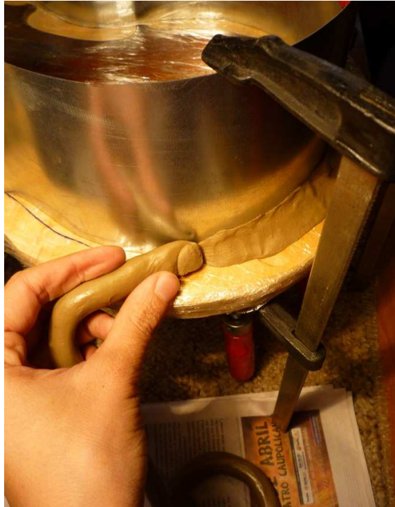
Fig. 60: Aplicación de masilla para vidrio.
