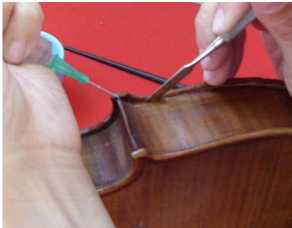
Fig. 49: Proceso de apertura del violín. Humectación del adhesivo orgánico con agua tibia.
