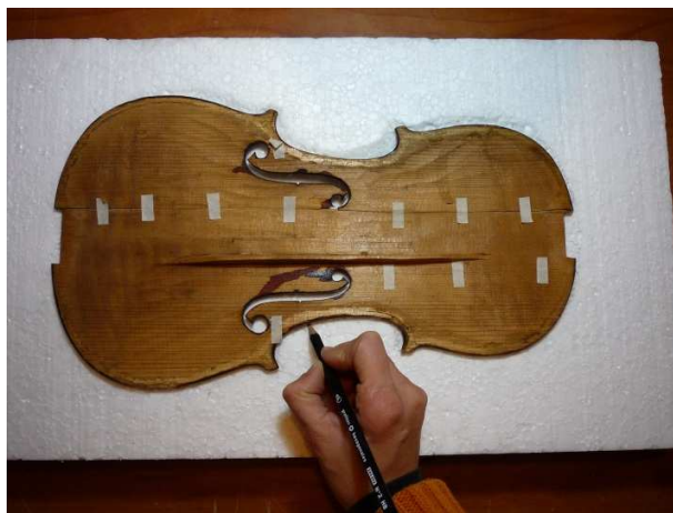
Fig. 33: Dibujando el contorno de la tapa para la cama soporte.
