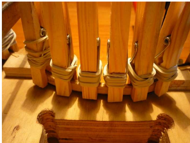
Fig. 98: Proceso de adhesión de contra-fajas.
