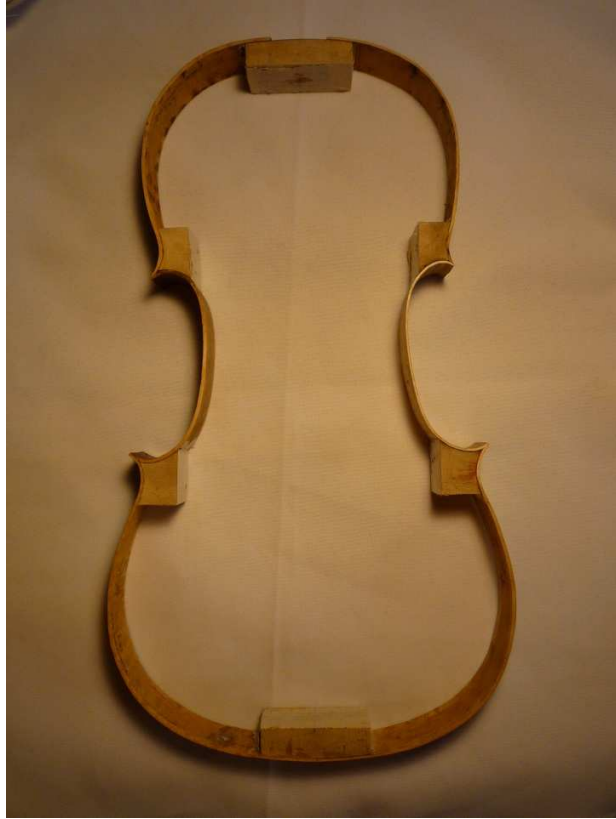
Fig. 96: Fajas adheridas a los tacos.
