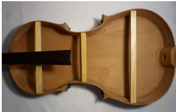
Fig. 14: Listones instalados en la caja de resonancia.
