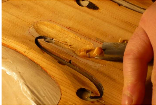
Fig. 66: Tallado de bajorrelieve para doblaje de alma.
