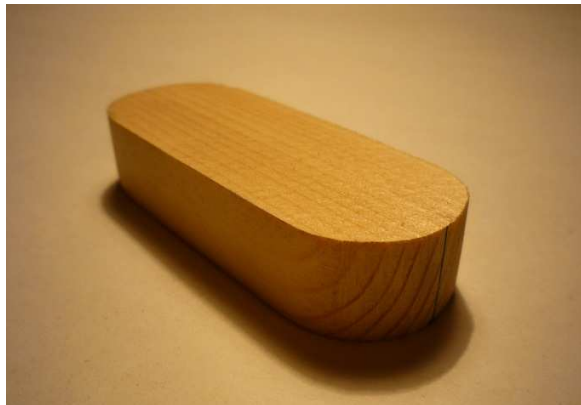
Fig. 64: Óvalo de madera de abeto para doblaje de alma.
