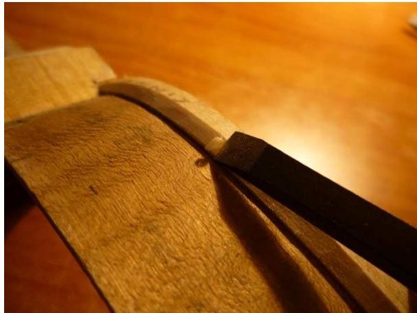
Fig.99: Tallado de borde interno de contra-fajas.
