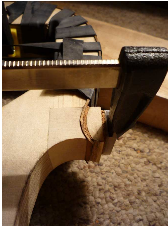
Fig. 89: Detalle del extremo de la faja en proceso de adhesión al taco lateral.
