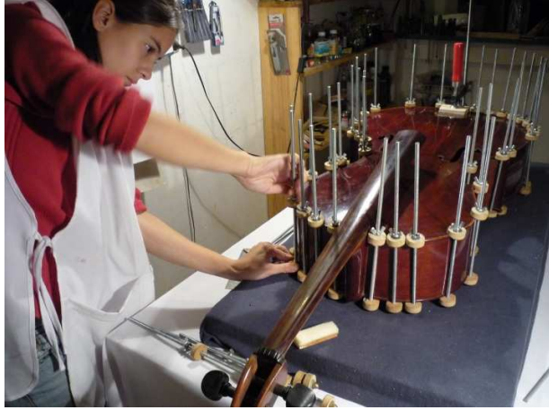
Fig. 25: Proceso de postura de prensas para el cierre del instrumento.
