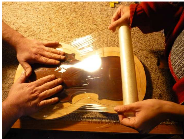
Fig. 58: Proceso de protección de tapa armónica para elaboración de molde de yeso.
