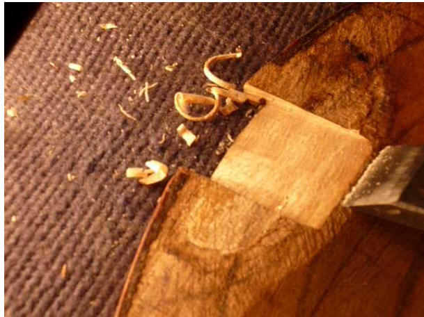
Fig. 101: Tallado del fondo para doblaje de botón.
