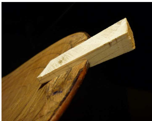
Fig. 103: Ensamble de abeto al fondo armónico para doblaje de botón.
