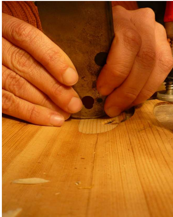
Fig. 74: Nivelación del doblaje con la superficie de la tapa.
