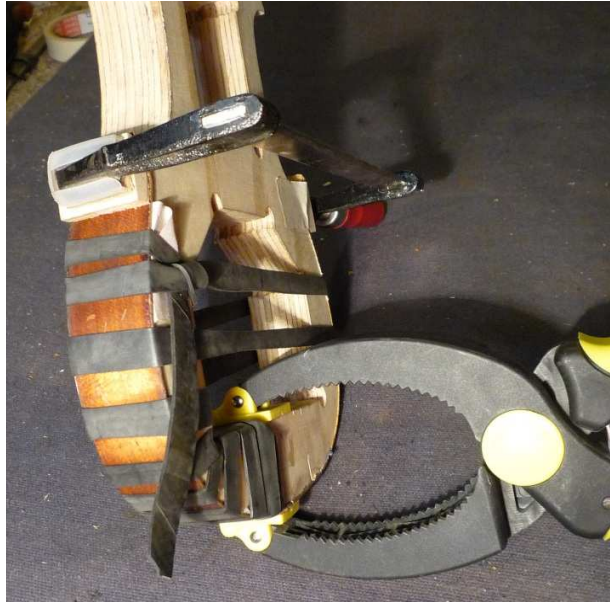
Fig. 90: Proceso de adhesión de las fajas a los tacos y amoldamiento a la matriz.
