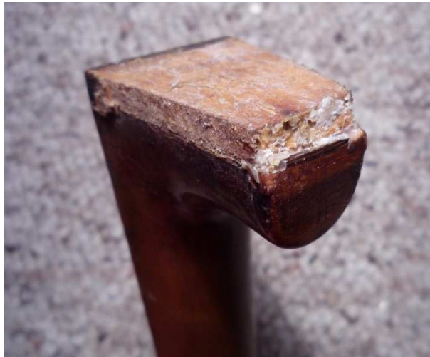
Fig. 55: Detalle del encastre con restos de adhesivo.
