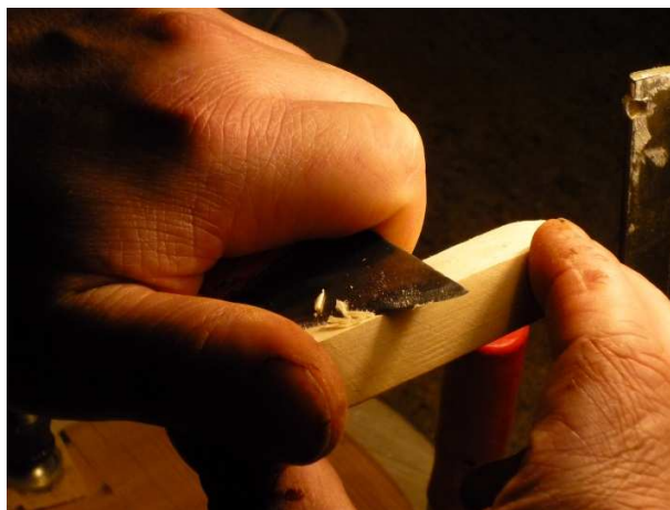
Fig. 71: Tallado de la curvatura del abeto para doblaje.
