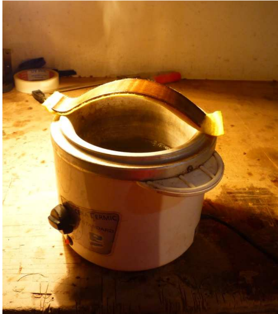
Fig. 88: Proceso de humectación de las fajas con vapor de agua.
