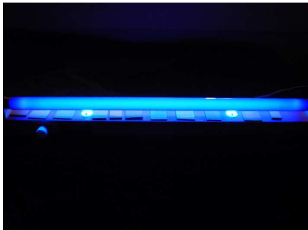
Fig. 110: Pruebas de imprimación en maderas de abeto y arce, bajo exposición de luz U.V.
