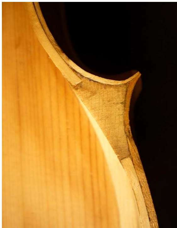
Fig. 105: Detalle final de taco lateral y contra-fajas.
