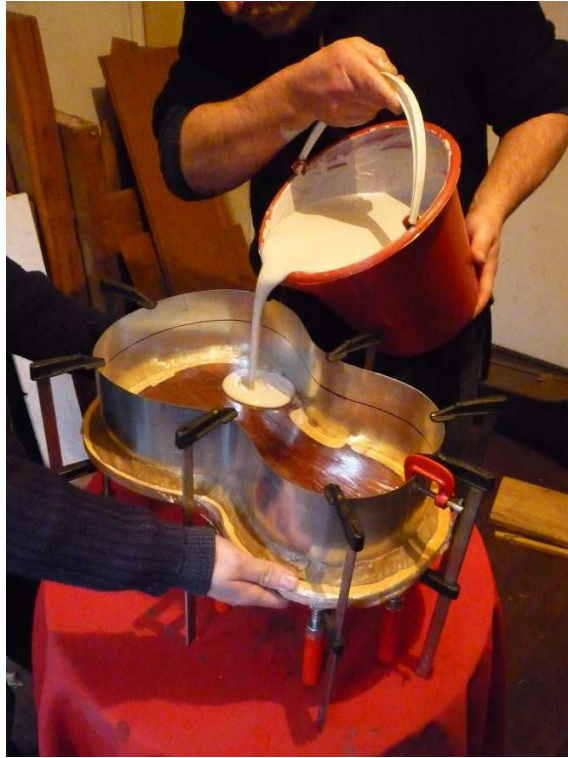
Fig. 61: Vertido de yeso sobre la tapa armónica.
