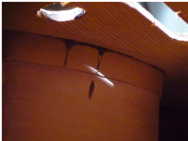
Fig. 10: Endoscopía. Se observa exceso de adhesivo, esta vez de un tipo diferente al de la figura anterior.
