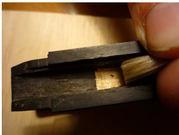
Fig. 118: Detalle de la cuña encajada en la morteza.
