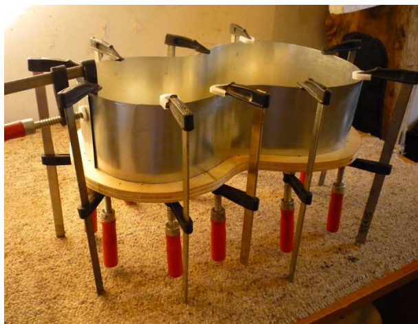
Fig. 59: Pared contenedora para vertido del yeso.
