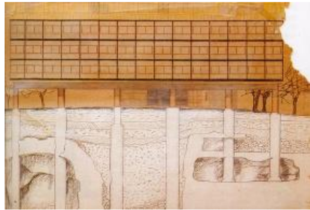
Fig. 39 Le Corbusier. Fundaciones del Pabellón suizo. París, 1950.
