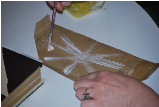
Fotos 68-70: Corte de la pieza de papel marmolado que constituirá la encuadernación holandesa, a la pieza se le aplica PVA (véase glosario)
