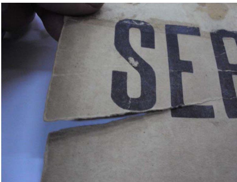
Foto 215: Se observa pérdida de la resistencia al desgarro
