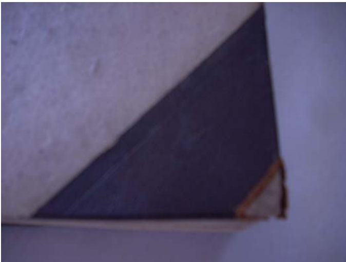
Foto 5: Deterioro en punteras de cuero por efecto de roce con la superficie. El cuero con el paso del tiempo se encontró reseco y quebradizo
