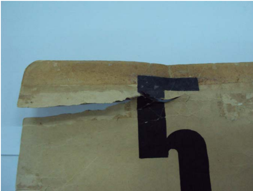
Foto 214: Hoja de calendario que muestra la pérdida de resistencia del papel cartulina ante 2 fuerzas específicas
