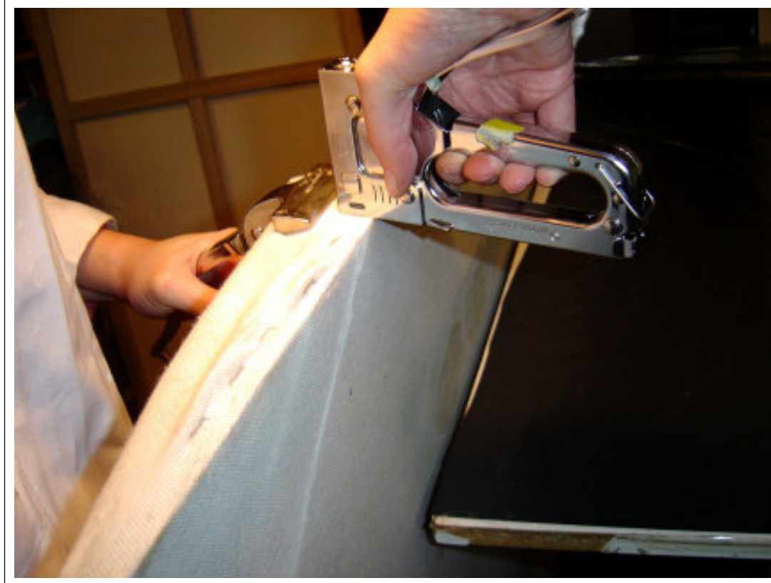
Foto 23. La fotografía muestra la fijación de la tela al bastidor con una grapadora, sin dejar de tensar. Esta herramienta manual, gracias a un mecanismo de percusión, permite clavar grapas en una superficie, embutiéndolas firmemente.
