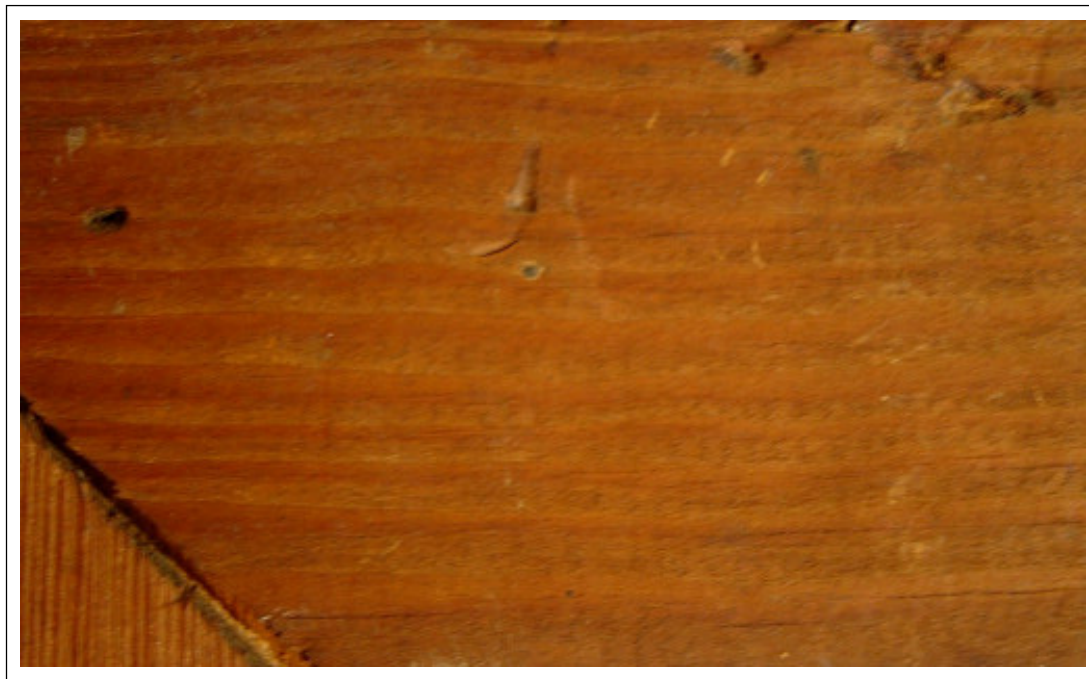
Foto 6. Macrofotografía del bastidor donde se observan pequeñas marcas de presiones sobre la madera.
