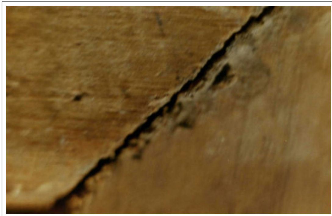
Macrofotografía que nos muestra las malas uniones y terminaciones del bastidor original.
