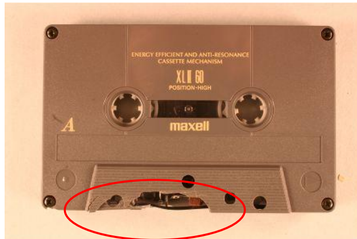
Fig. 19: Ejemplo de rotura en una carcasa de compact cassette . (NEW YORK UNIVERSITY LIBRARIES. Op. Cit. , p. 4)
