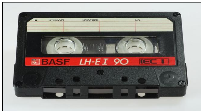
Fig. 1: Vista de un cassette mostrando las aberturas por donde la cinta es expuesta para permitir su borrado, grabación y reproducción.
