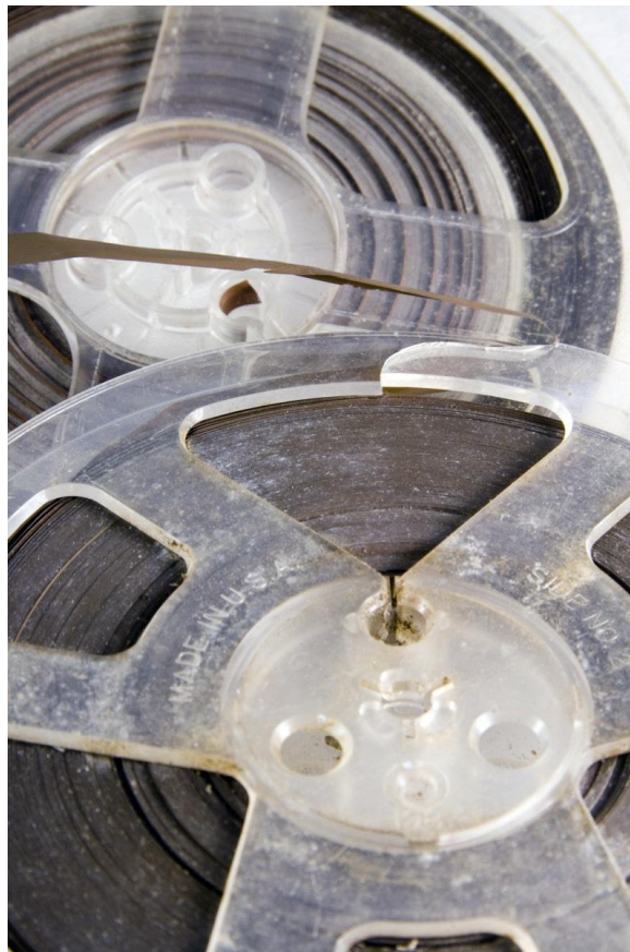
Fig. 16: Hongos en una cinta de carrete abierto. (CASEY, Mike. FACET Format Characteristics and Preservation Problems Version 1.0 . 2007. p. 30)
