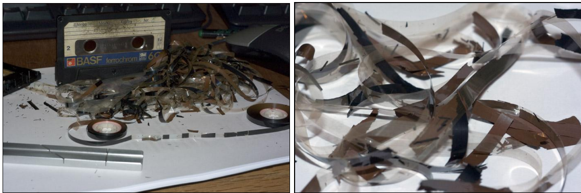
Figs. 12 y 13: Caso de delaminación de una cinta de cassette. ( http://richardhess.com/notes/2006/03/31/project-notes-advanced-oxide-delamination-of-a-cassette/ )
