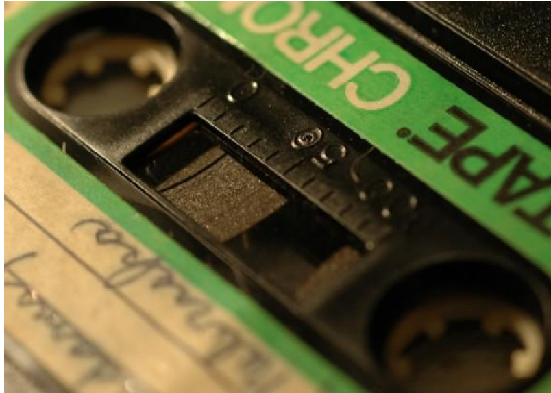
Fig. 18: Depósitos de cristal en una cinta de cassette. (SUEIRO, Marcos. AVDb Audio and Moving Image Survey Tool Instruction Manual . 2008. p. 12)
