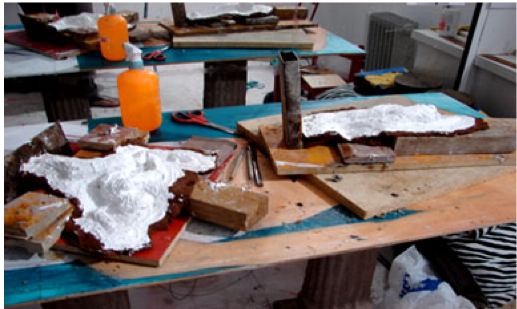
Foto : moldes de goma de silicona. Esto se cubre con yeso. Luego esto se voltea, se saca la cama de greda, se aísla (con cera o esterina) y se repite el proceso. Una vez duro se abre.
