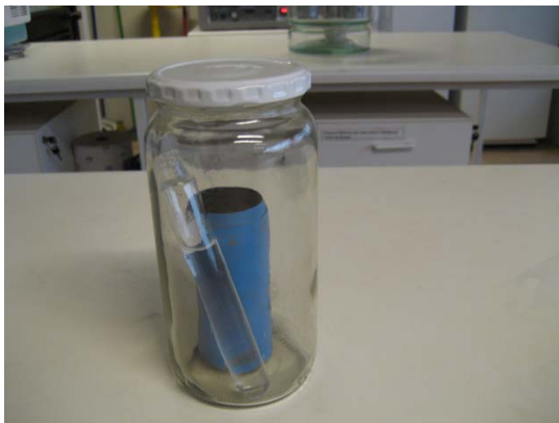
Figura 6. Determinación de respiración en muestras de suelo no disturbadas utilizando una solución de NaOH como trampa de gases. El CO 2 desprendido desde la muestra difundió y fue absorbido por la solución alcalina.
