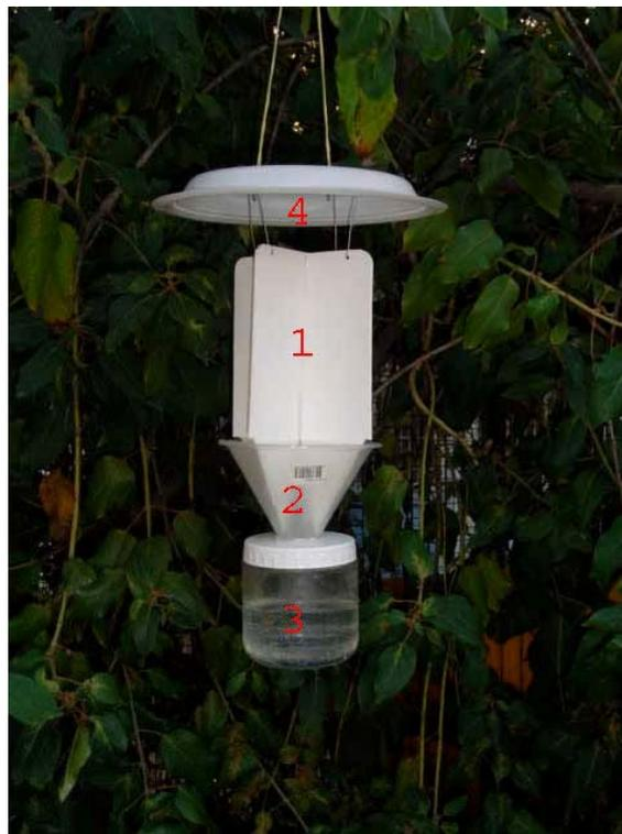
Figura 3. Trampa utilizada para la colecta de coleópteros voladores. Los números señalan las diferentes partes explicadas en el texto.
