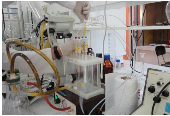
Fotografía G7.16.: Instalación de los cartuchos para proceder a las extracciones
