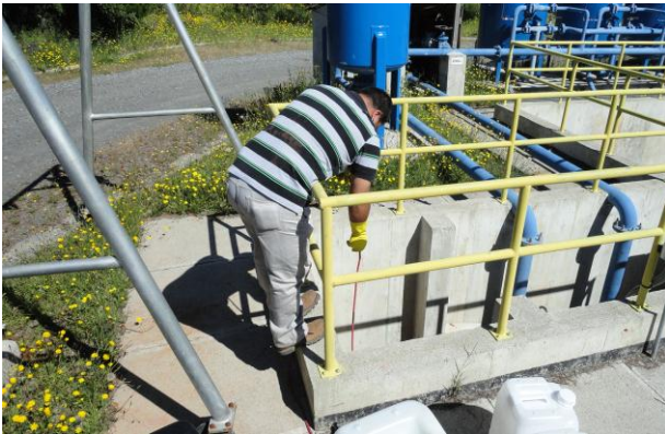
Fotografía G7.5.: Muestreo aguas servidas planta comuna de Santa Bárbara, descarga del decantador final (efluente de la planta)
