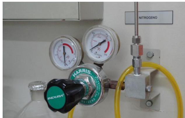
Fotografía G7.25.: Equipo regulador de Nitrógeno para última etapa de concentración de muestras y llevarlas a viales
