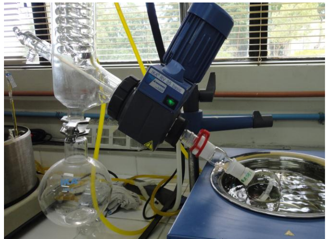
Fotografía G7.22: Concentración de la muestra por evaporación en baño de agua
