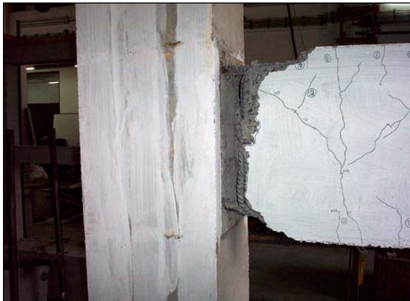
Foto nº 10: Fotografía de la falla a drift de 4%.
