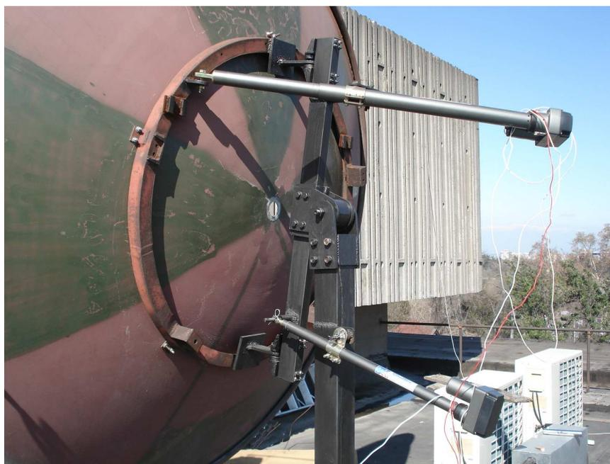
Figura 4.5: Actuadores lineales colocados en la montura
