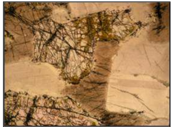
Figura 3-16: Microfotografía de la muestra fresca de troctolita de clinopiroxeno (TN0723C). Costa oeste de I. Milne Edwards. (luz polarizada plana, luz no polarizada)
