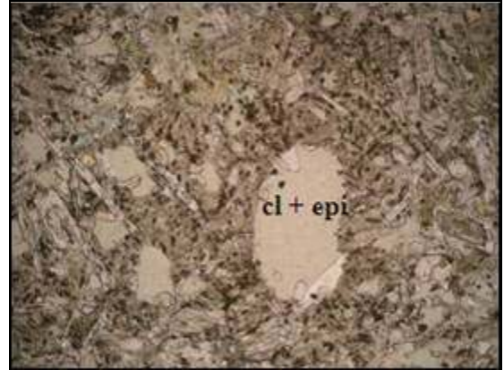
Figura 4-1: Microfotografía de la muestra TN0705C. Se aprecia clorita y epidota en una masa fundamental recrystalizada (luz polarizada plana y luz no polarizada)
