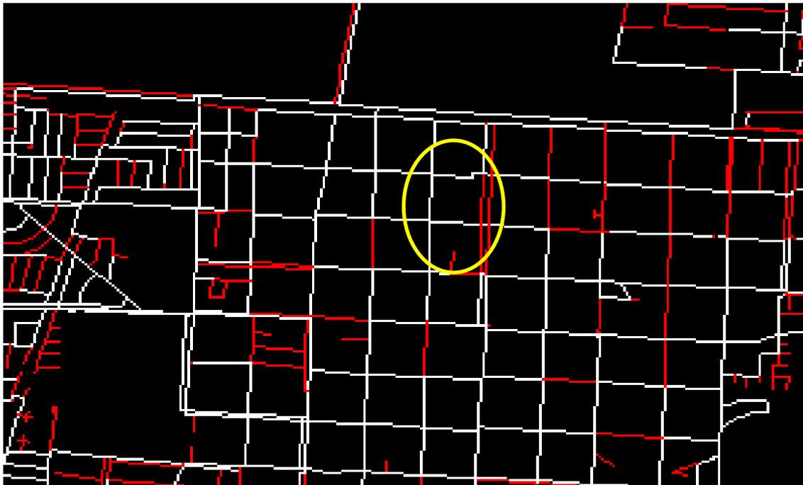
El resultado de dicho modelamiento se presenta en la figura 16, cabe destacar que se alcanzaron velocidades de lavado superiores a lo esperado del orden de los 3.6 m/s, para un caudal de 16 l/s. Esto sin duda nos indica que el efectuar un lavado hidráulico convencional en dicho sector es factible, eso si ocasiona un cambio en los flujo del sistema disminuyendo las velocidades en
