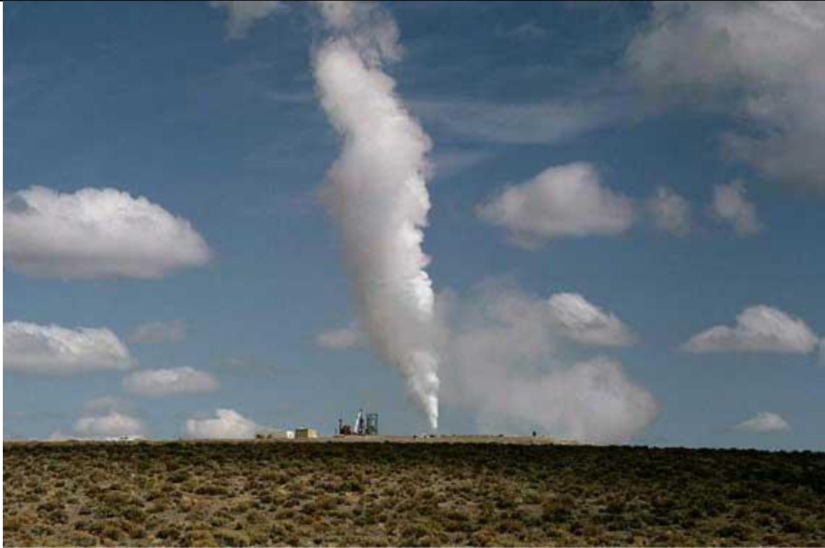
Fig. I-8 Prueba de pozos exploratorios para geotermia en el desierto de Nevada, E.E.U.U. La columna que se aprecia en la fotografía corresponde a vapor de agua. Foto Geothermal Education Office.
