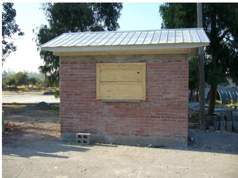
Importante notar que se fabricó una protección de ventana, con el fin de evitar el paso de radiación directa hacia el interior de la caseta, para así poder realizar ensayos con la caseta sometida a estas solicitaciones y otros donde no lo estuviera.
