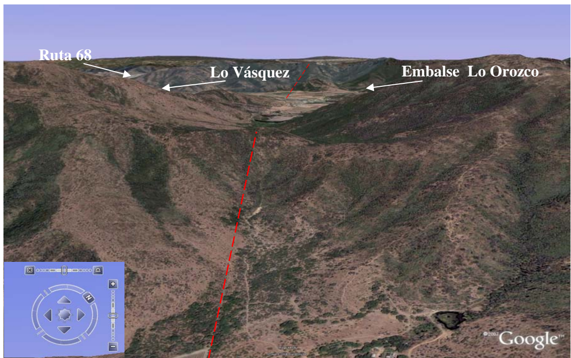
Figura 4.11: Imagen de Google Earth, donde se observa el lineamiento correspondiente a la falla Valparaíso marcado por la línea roja discontinua.
