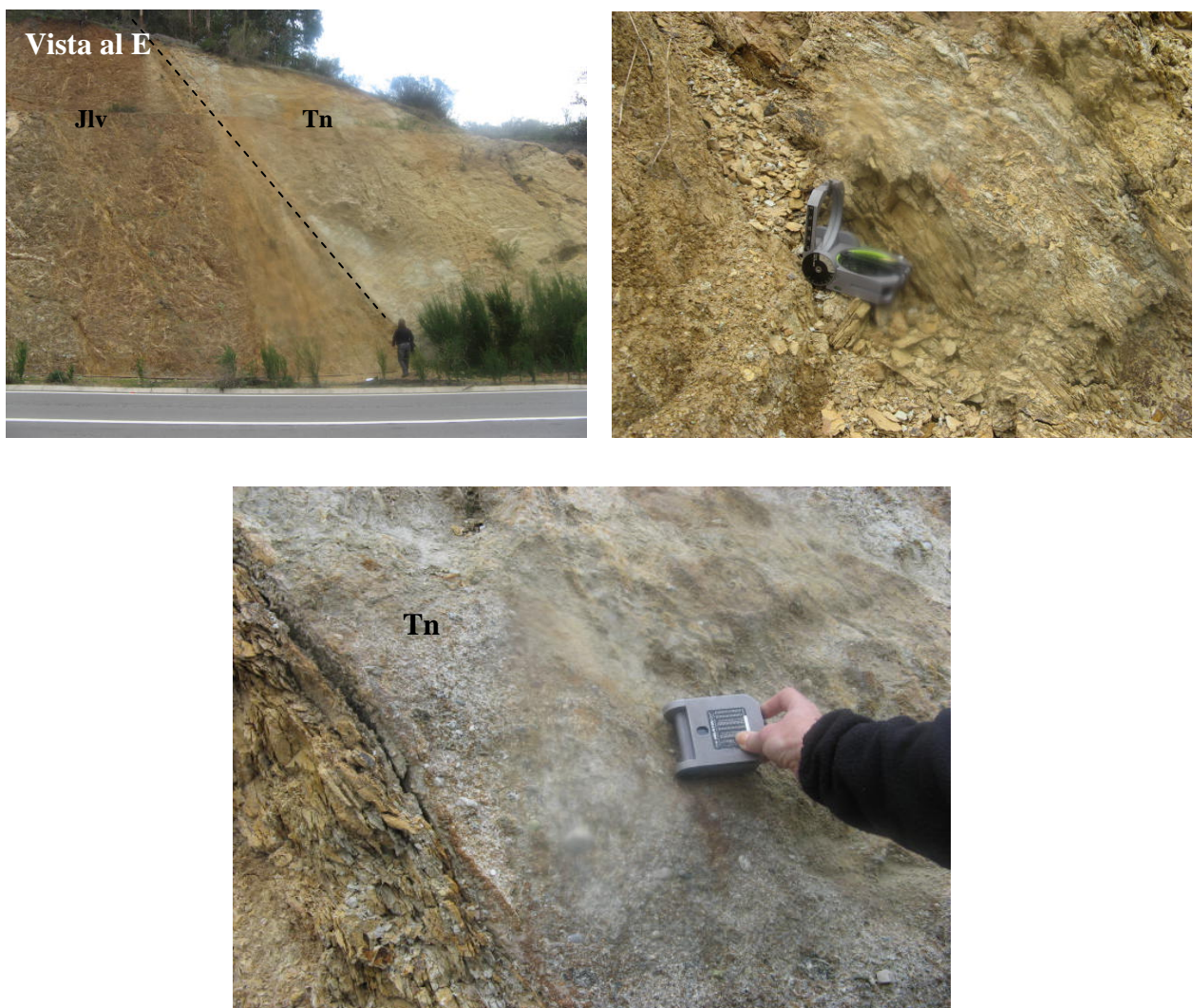
Figura 4.12: Fotografías tomadas en sector Laguna Verde. Se observa un contacto por falla normal entre roca sedimentaria (Tn: Fm Navidad) y roca intrusiva (Jlv). Orientación N58^{\circ}W .
