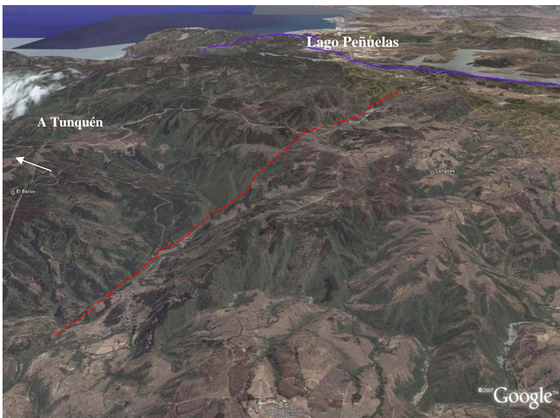
Figura 4.24: Imagen modificada de Google Earth, en la que se observa el lineamiento correspondiente a la estructura 1 (Las Melosillas) marcado con una línea roja discontinua.
