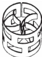
**Figura A.1: Empaque tipo Anillo Pall.**
