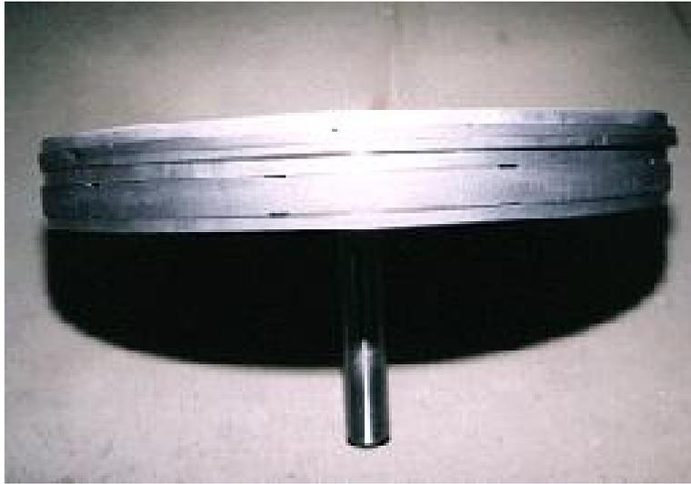
Figura 3.10: Pistón de motor Stirling construido por la Universidad de Saitama.
