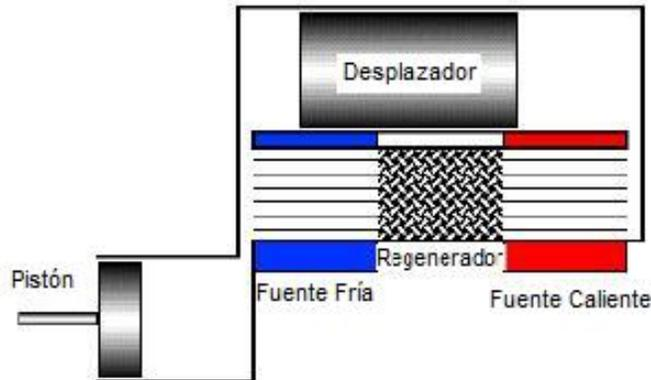
Figura 3.4: Ejemplo de motor Stirling tipo Gamma.
