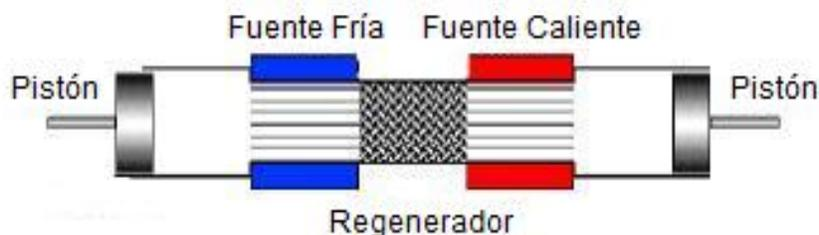
Figura 3.2: Ejemplo de motor Stirling tipo Alfa.
