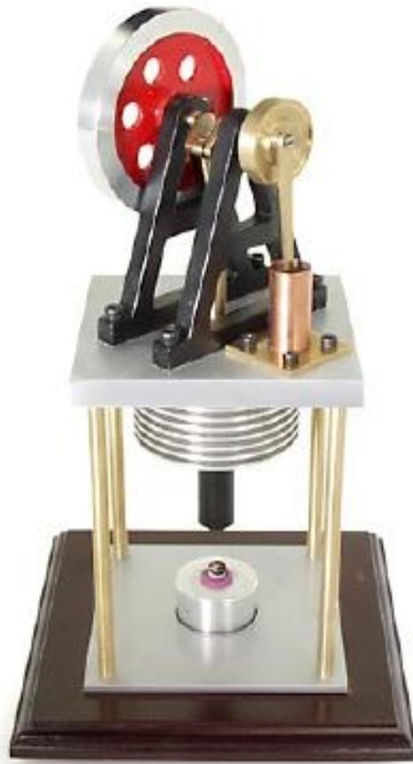
Figura 3.13: Prototipo de motor Stirling utilizado en Departamento de Ingeniería Eléctrica.
