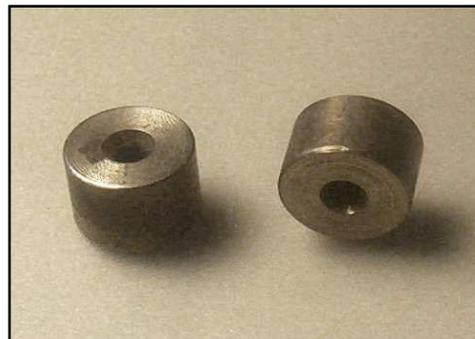
Figura 2.4.2 Topes metálicos, con dimensiones de 5mm de altura y 8mm de diámetro, estos son colocados en tres de las caras de las probetas separados por 10''.
