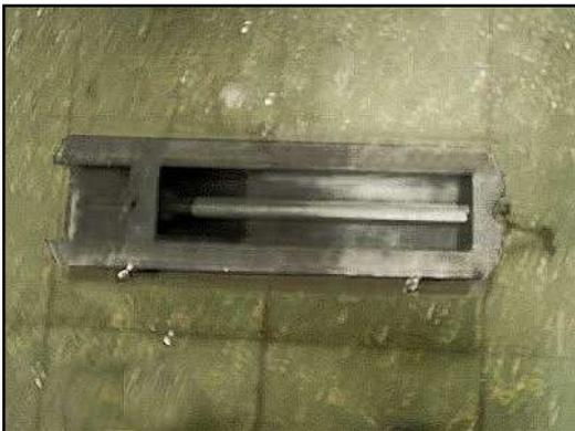
Figura 2.10.1 Molde utilizado, este es uno de los moldes utilizados para la confección de las probetas, en esta foto se puede ver como la forma del mismo y la ubicación del eje.
