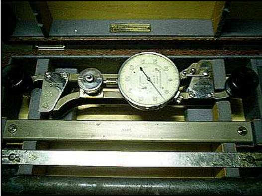
Figura 2.4.3 Extensómetro, de arriba hacia abajo se pueden ver: equipo de medición, barra patrón de lectura y herramientas de colocación de los topes metálicos.
