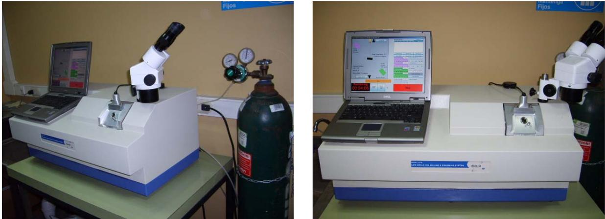
Figura 23. Equipo de erosión por iones: Low Angle Ion Milling & Polishing Sistem, modelo 1010.
