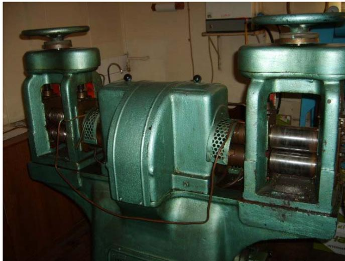
Figura 15. Máquina laminadora utilizada para el trabajo en frío.
