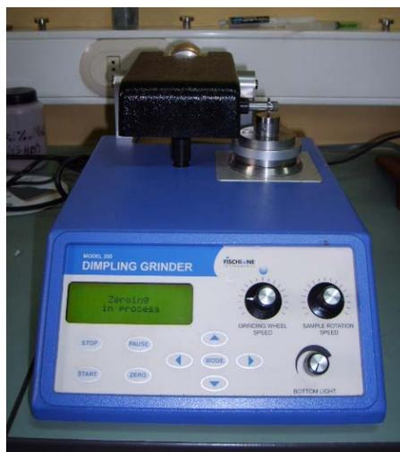
Figura 21. Equipo de pulido Dimpling Grinder.
