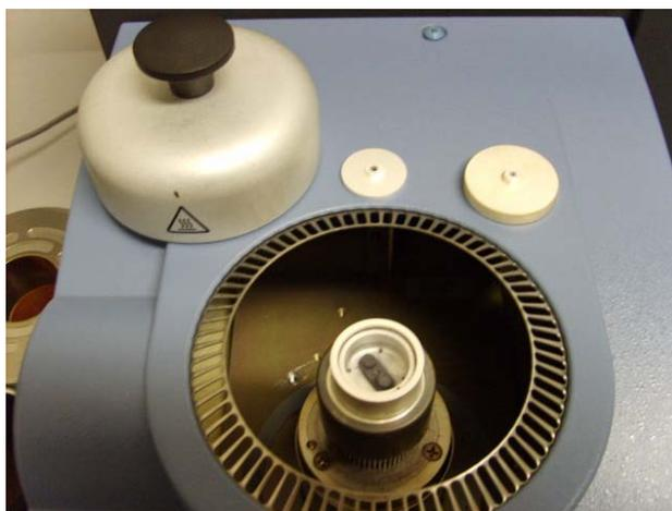
Figura 10. Equipo DSC Q20, TA Instruments. Unidad porta-muestras.
