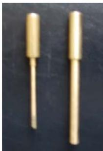
Figura 17. Herramientas de corte de discos. Izquierda: discos de 3 mm (TEM). Derecha: discos de 6 mm (DSC).
