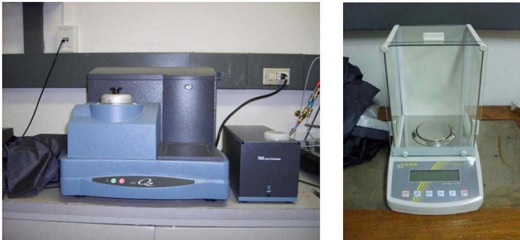
Figura 18. Izquierda: Equipo DSC Q20, TA Instruments. Derecha: Balanza de precisión utilizada.
