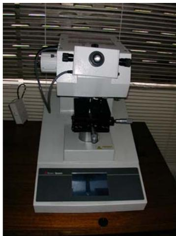
Figura 19. Microdurómetro Struers, modelo Duramin-1.
