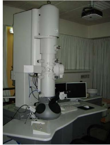
Figura 24. Equipo HR-TEM, TECNAI F20. En la foto de la izquierda puede apreciarse la unidad EDS.
