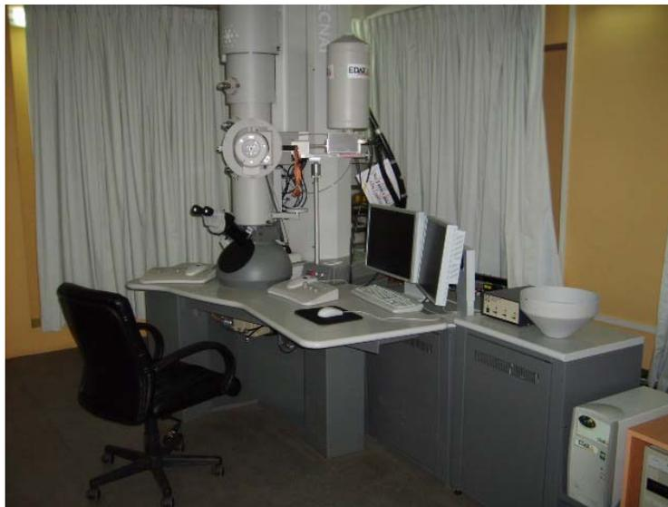
Figura 12. Microscopio Electrónico de Transmisión de Alta Resolución (HR-TEM).
