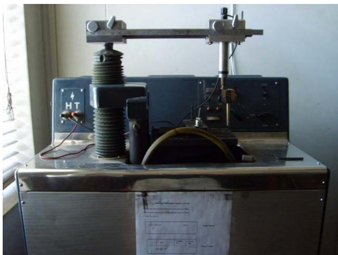
Figura 16. Máquina de corte por electroerosión “spark cutter” utilizada para el corte de probetas.
