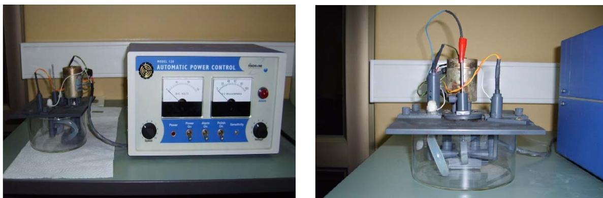
Figura 22. Izquierda: Equipo de pulido electroquímico. Derecha: Unidad Twin-Jet Electropolisher, modelo 110.
