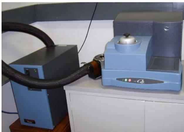
Figura 9. Equipo DSC Q20, TA Instruments. A la izquierda puede observarse el “cooler”.
