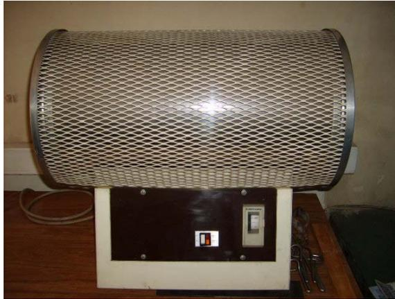
Figura 20. Horno tubular Eurotherm usado para recristalizar el material.
