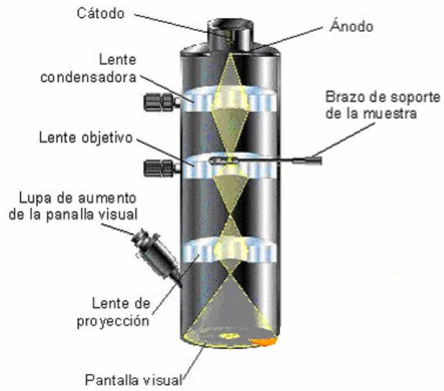
Figura 13. Esquema funcional de un Microscopio Electrónico de Transmisión.
