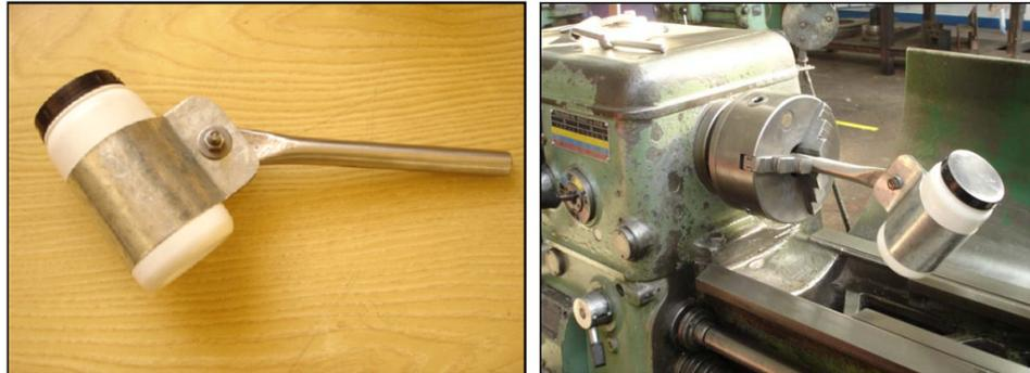
Figura 5.1: Procedimiento de homogenización de los polvos. (a) Brazo en ángulo con el contenedor. (b) Sistema instalado en un torno.
