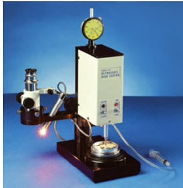
Figura 5.9: Cortador de discos ultrasónico utilizado en el laboratorio. Marca Fischione Instruments, modelo 170.
