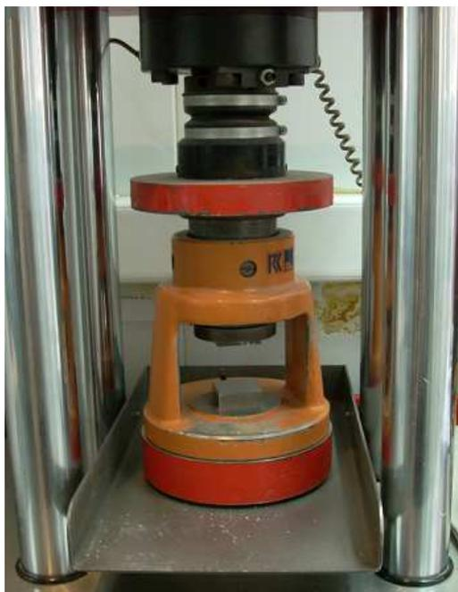
Figura N°7: Máquina de ensayo de resistencia a la compresión.
