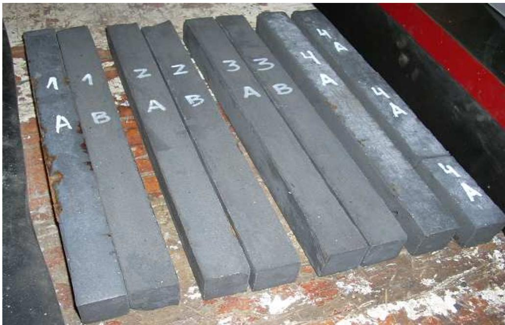
Figura N°8: Probetas confeccionadas con la mezcla en distintas dosificaciones puzolánicas.
