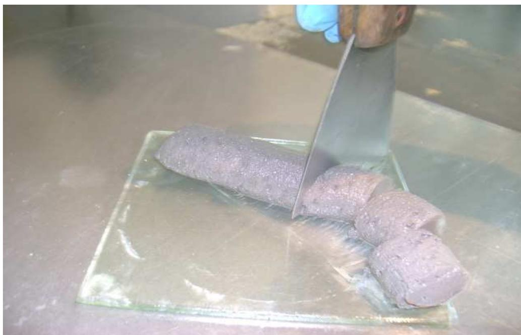
Figura N°12: Formación del pellet mediante la división del material extruído.
