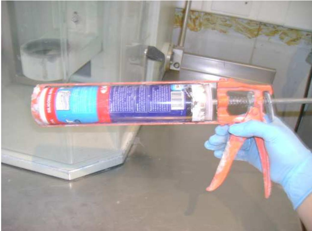
Figura N°10: Pistola extrusora utilizada en proceso de pelletización.
