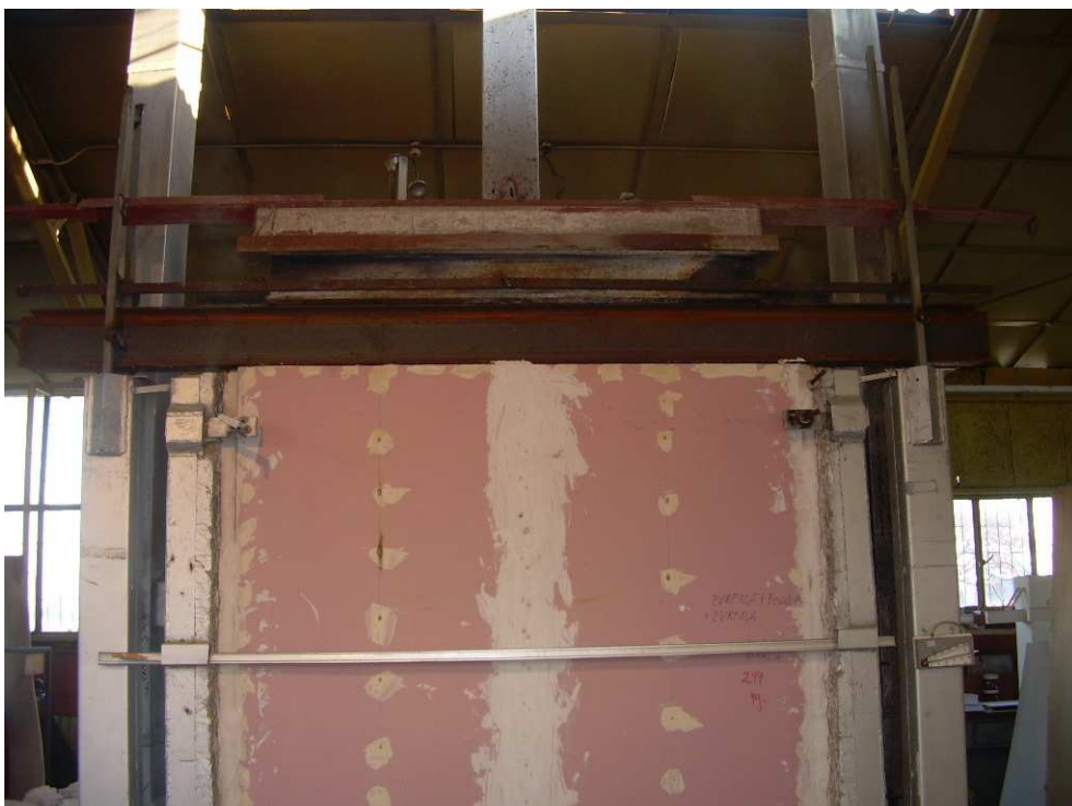
Figura N° 25 : Esquema de montaje de cargas en paneles.
