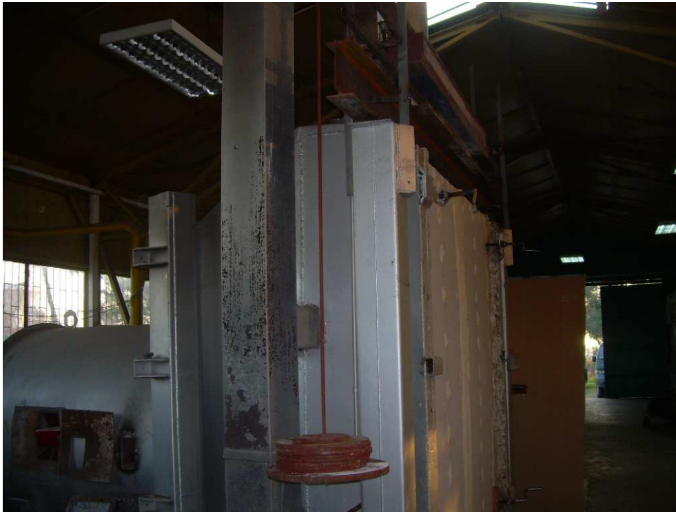
Figura 24: Muro de ensayo N°3 instalado en horno.
