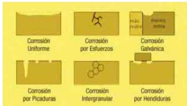
Figura 2.2: Algunos de los tipos de corrosión más comunes por influencia del medio, la estructura y composición del metal
