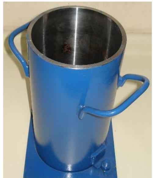
Fig. 8: Molde cilíndrico
