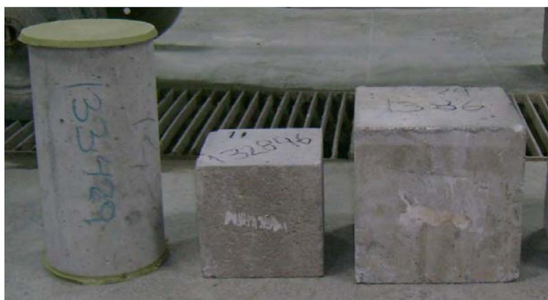
Fig. 1: Tipo de probetas ensayo a compresión
