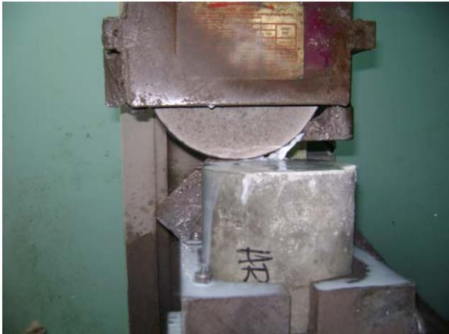
Fig. 11: Rectificado de cilindro.
