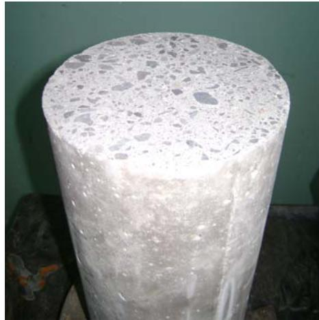
Fig. 12: Cilindro rectificado.
