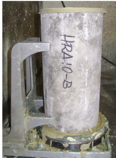
Fig. 13: Refrentado de cilindro
