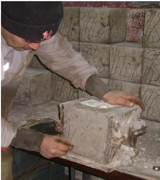
Fig. 5: desmolde e identificación de probetas.
