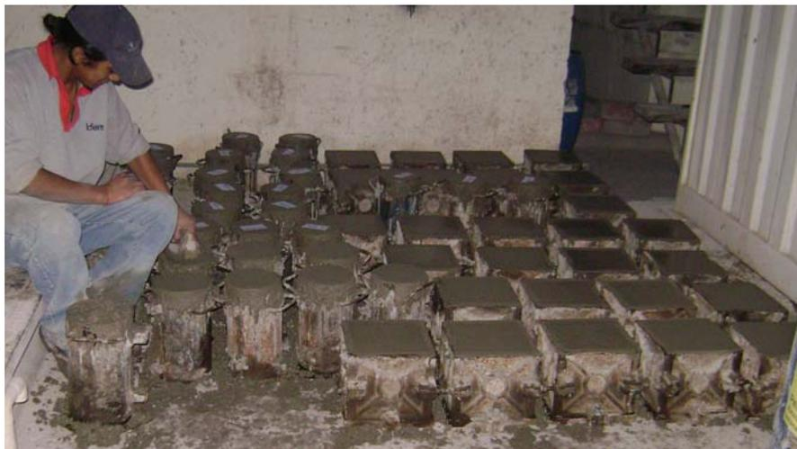
Fig. 4: Confección de probetas.
