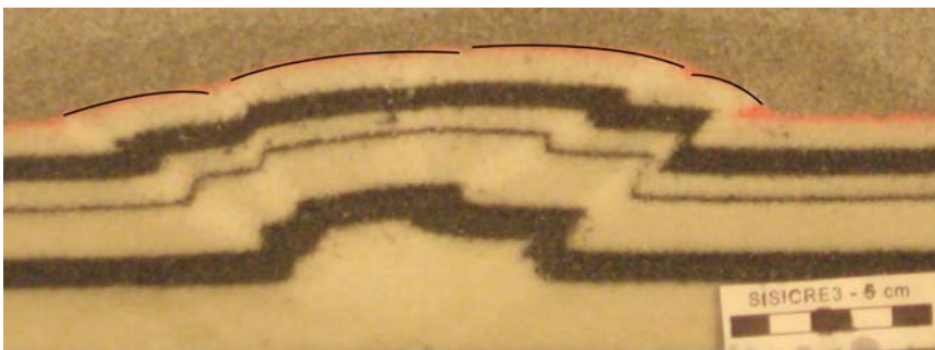
Figura 5-2. Perfil del modelo SISICRE 3 con los plegamientos marcados sobre la capa de arena roja.
