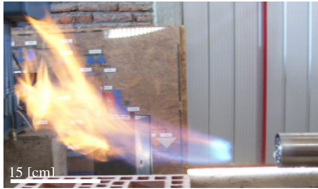
Figura 22: “Flujo de gas: 7.2 [L/min]; Flujo de aire radial: 0 [L/min]; Flujo de aire axial: 0 [L/min]”
