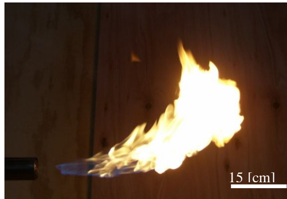
Figura 27: “Flujo de gas: 11.4 [L/min]; Flujo de aire radial: 0 [L/min]; Flujo de aire axial: 0 [L/min]”
