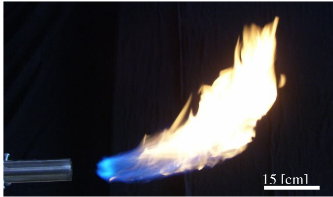
Figura 36: “Flujo de gas: 14.25 [L/min]; Flujo de aire radial: 30 [L/min]; Flujo de aire axial: 30 [L/min]”
