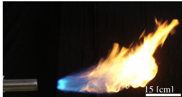
Figura 43: “Flujo de gas: 19 [L/min]; Flujo de aire radial: 30 [L/min]; Flujo de aire axial: 0 [L/min]”
