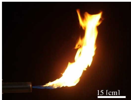
Figura 40: “Flujo de gas: 4.75 [L/min]; Flujo de aire radial: 30 [L/min]; Flujo de aire axial: 0 [L/min]”
