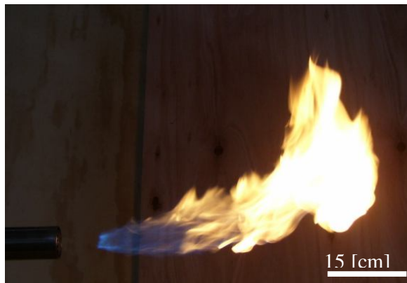
Figura 28: “Flujo de gas: 14.25 [L/min]; Flujo de aire radial: 0 [L/min]; Flujo de aire axial: 0 [L/min]”
