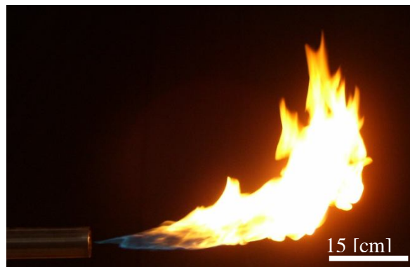
Figura 47: “Flujo de gas: 9.5 [L/min]; Flujo de aire radial: 0 [L/min]; Flujo de aire axial: 30 [L/min]”
