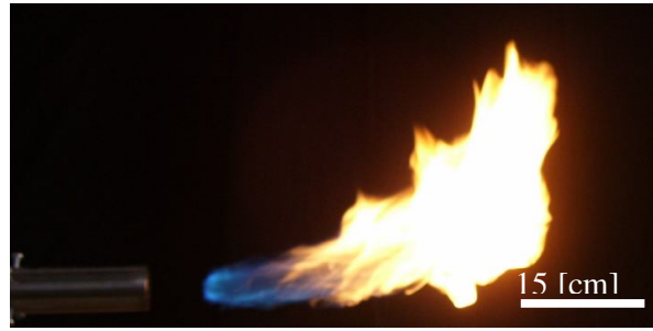
Figura 42: “Flujo de gas: 14.25 [L/min]; Flujo de aire radial: 30 [L/min]; Flujo de aire axial: 0 [L/min]”
