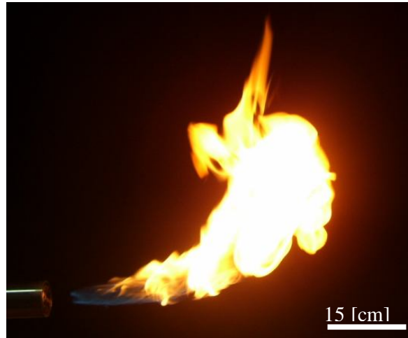
Figura 31: “Flujo de gas: 8.55 [L/min]; Flujo de aire radial: 0 [L/min]; Flujo de aire axial: 0 [L/min]”
