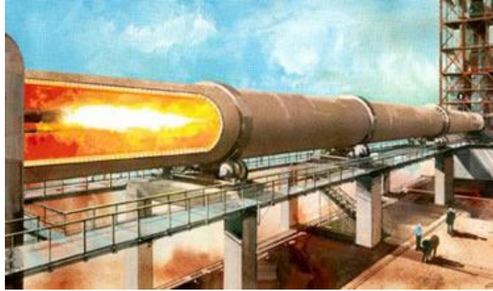
Figura 3: “Horno Rotatorio, se presenta un corte en la zona de calcinación a fin de ilustrar el quemador”
