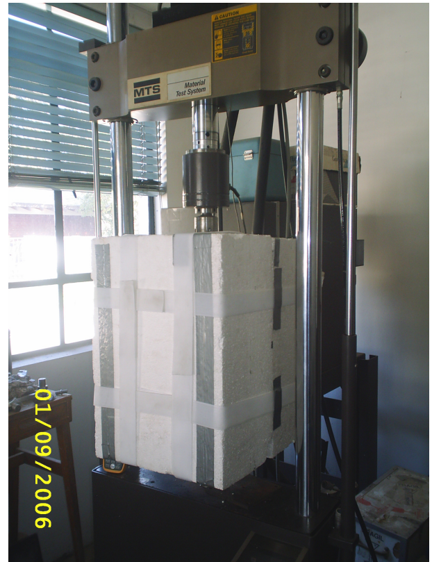
(b) Montaje caja aislante cerrada
