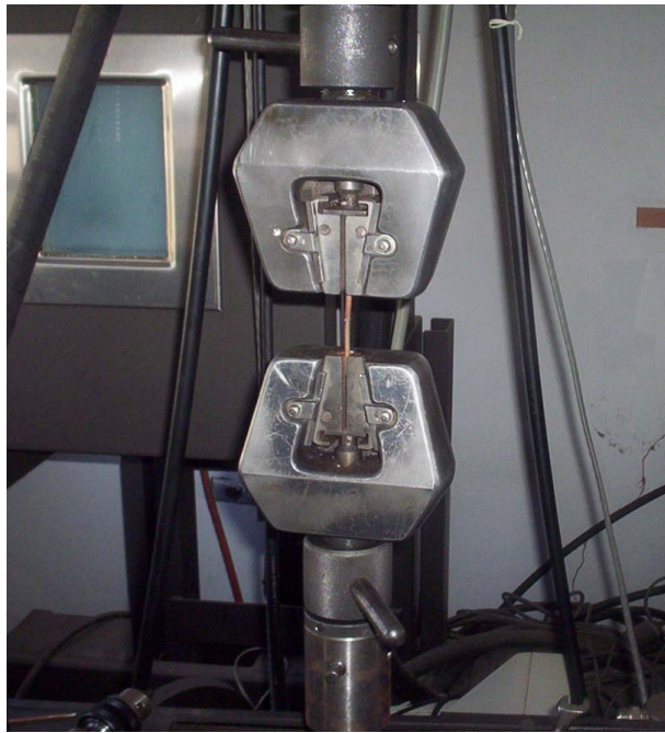
(a) Montaje Mordazas, vista general
