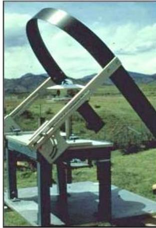
**Figura 2.16 Piranómetro de radiación difusa con anillo sombreador [17]**
