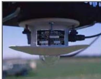
**Figura 2.17 Piranómetro de radiación solar reflejada [17]**
