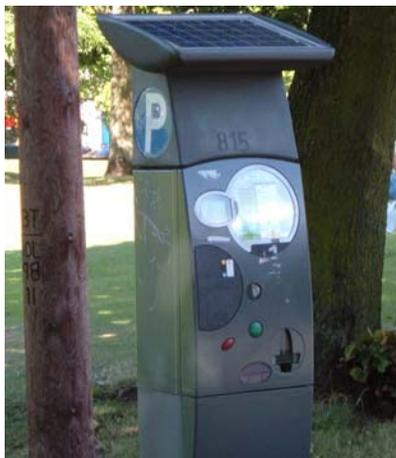
Figura 2.46 Parquímetro que utiliza celdas solares, Edimburgo, Alemania [43]
