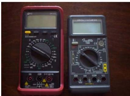
Figura 5.6 Multímetros utilizados en las mediciones
