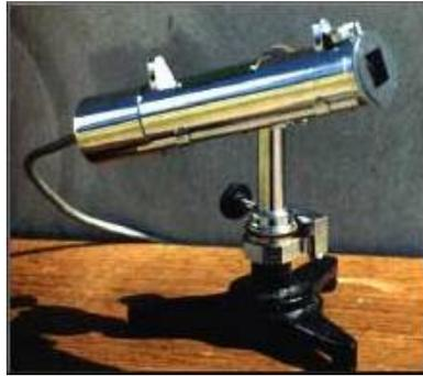
**Figura 2.18 Pirheliómetro Angstrom [17]**
