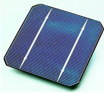
Figura 2.26 Celda de Silicio Monocristalino [29]
