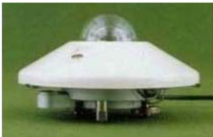
Figura 2.15 Piranómetro de Radiación Global [17]
