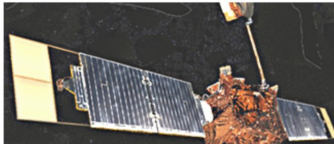
Figura 2.48 Paneles Solares y de frenado del Mars Global Surveyor [46]
