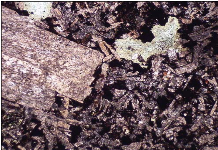
Muestra M-3: aspecto de la roca con fenocristales de plagioclasa en masa fundamental intergranular. Aum.: 5X10; Nic. Cruzados.
