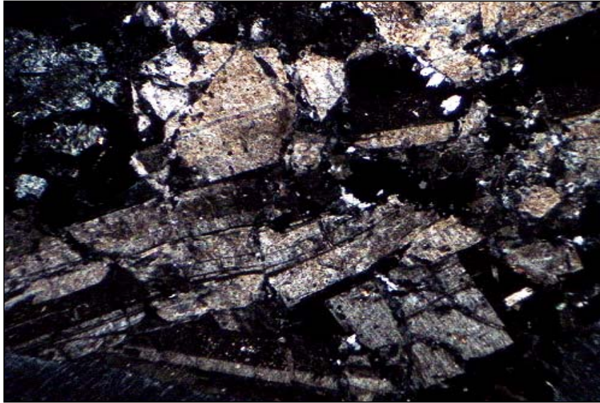
Muestra M-3: parte de la roca afectada por cizallamiento, con cristales de plagioclasa deformados y fracturados. Aum.: 5X10; Nic. Cruzados.
