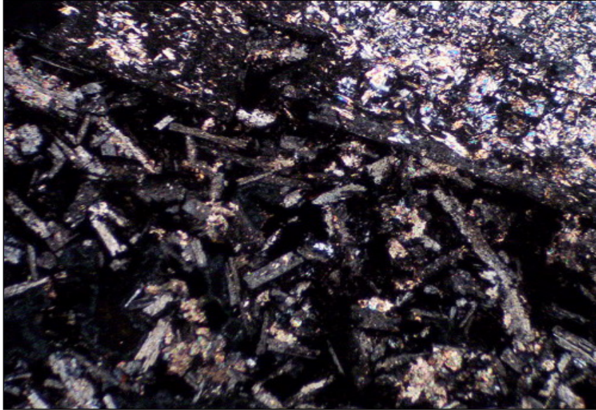
Muestra M-4: aspecto de la roca con fenocristales de plagioclasa parcialmente sericitizada en masa fundamental intergranular. Aum.: 5X10; Nic. Cruzados.
