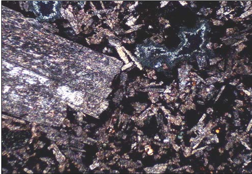
Muestra M-3: aspecto de la roca con fenocristales de plagioclasa en masa fundamental intergranular. Aum.: 5X10; Nic. Cruzados.
