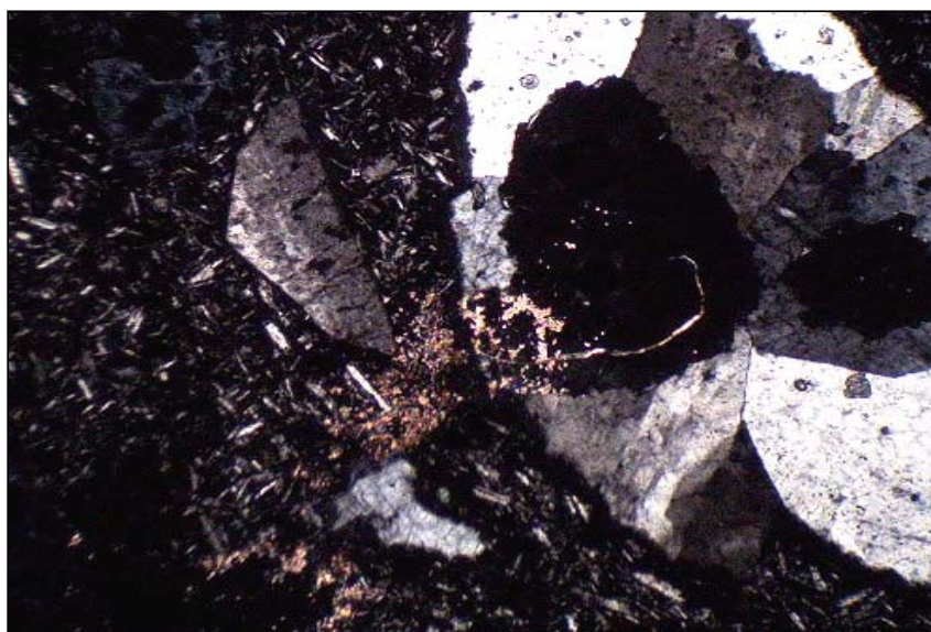
Muestra M-7: amigdala con relleno de cuarzo y escasa calcita, que se encuentra impregnada además impregnada en la roca. Aum.: 5X10; Nic. Cruzados.
