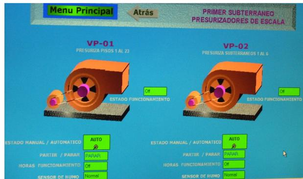
FIG. 5-11: CONTROL AUTOMÁTICO PRESURIZACIÓN
