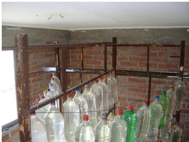
Los ensayos realizados con masa efusiva interior tienen el objetivo de cuantificar el aporte que generan las divisiones interiores de material pesado en el control de la temperatura al interior de las viviendas.
