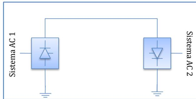
Figura 2.3: Configuración Monopolar
