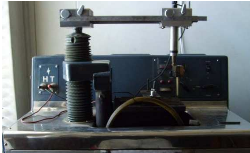
Figura 12: “Máquina de corte por electroerosión, utilizada para el corte de probetas”
