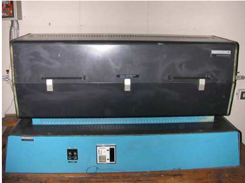
Figura 10: “Horno tubular Lindberg para tratamientos térmicos”
