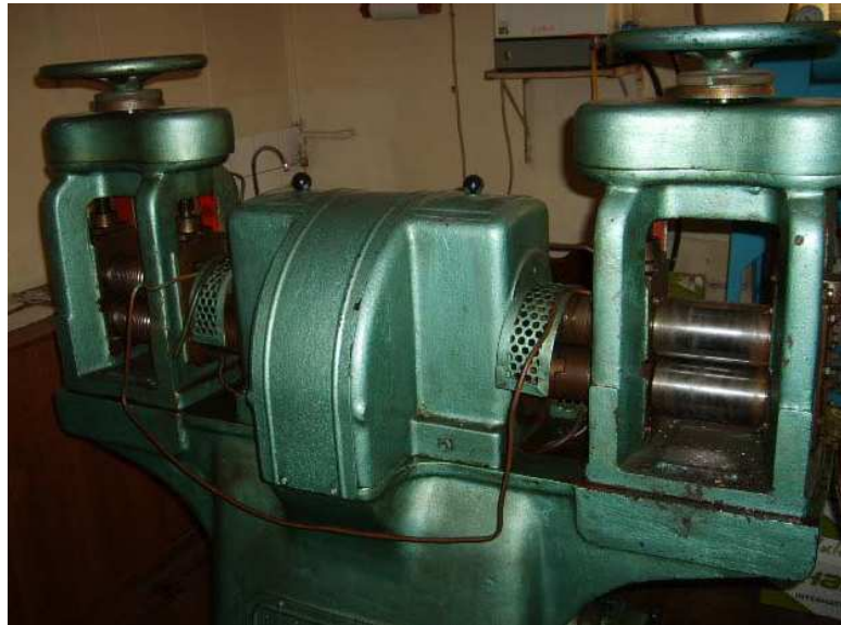
Figura 11: “Máquina laminadora utilizada para el trabajo en frío”
