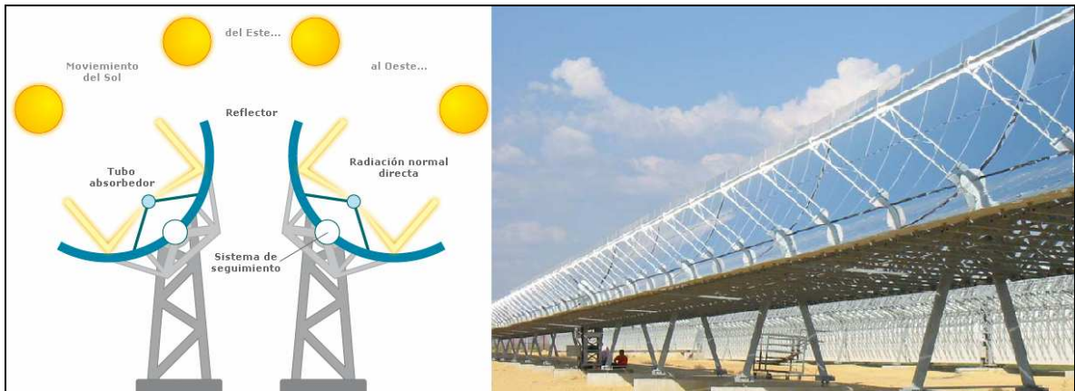
Figura 14: Tecnología Cilindros Parabólicos. Empresa Abengoa
