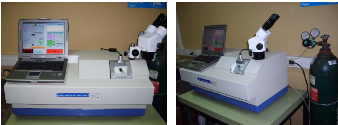
Figura 3.3: Equipo de erosión por iones: Low Angle Ion Milling & Polishing Sistem, modelo 1010.
