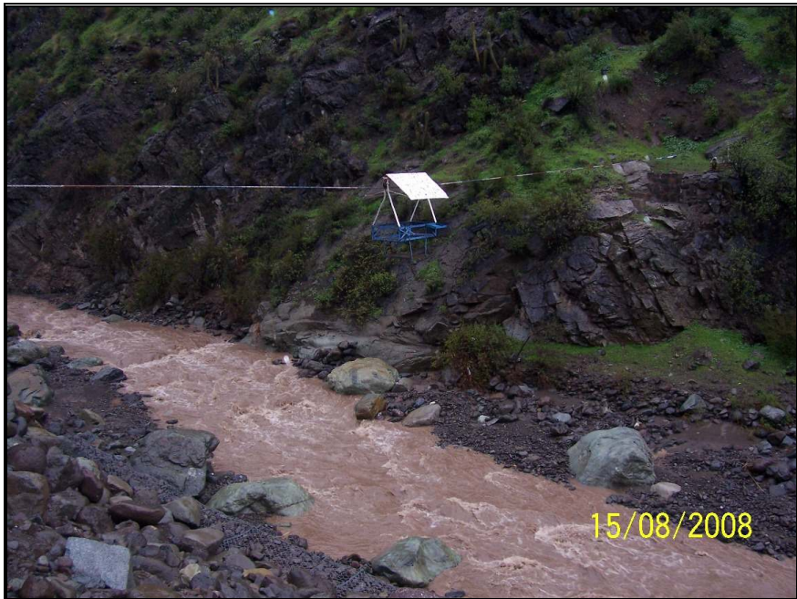
Foto N°4: Carro Hidromensor, Sección E.F. Río Colina en Peldehue
