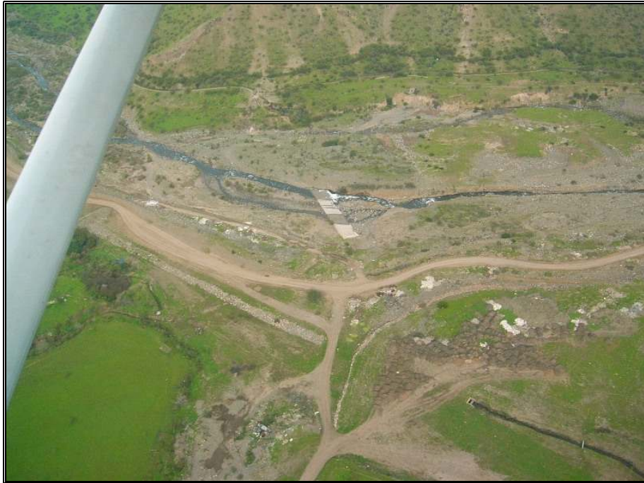
Foto N°1: Descalce del Sifón El Molino, Julio 2005
