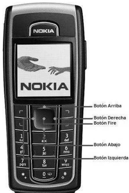
Figura 18: botones del joystick de un teléfono móvil.
